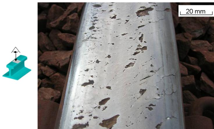
**Figure I.3-6 : Écaillages multiples de la bande de roulement de rail [SNC 02] Code UIC<sup>11</sup> 222**
