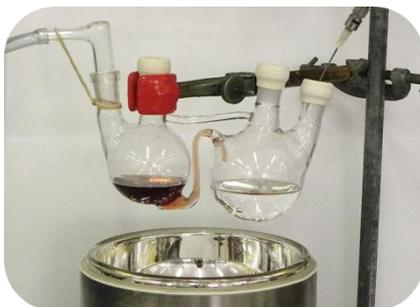
Figure 31 : Verrerie permettant de travailler avec de faibles variations de temp\u00e9rature
