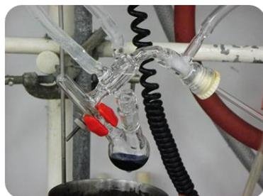
Figure 32 : Appareillage de distillation du THF- $d_8$  sur Na-PhCOPh
