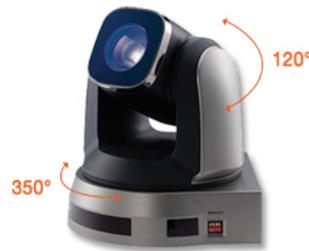
FIGURE 4.2 – Exemple de caméra PTZ
