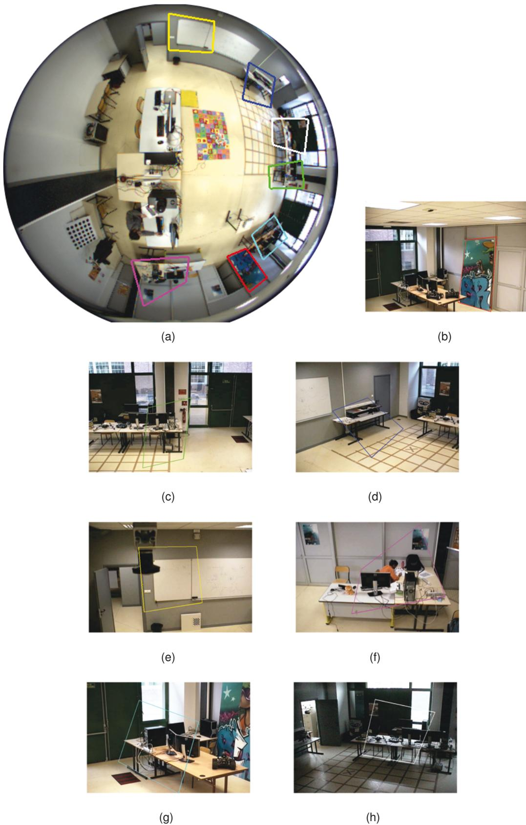
FIGURE 5.21 – Détection d'objets divers (a) Image *fish-eye* avec les cibles sélectionnées, (b) (c) (d) (e) (f) (g) et (h) cibles détectées sur les images PTZ
