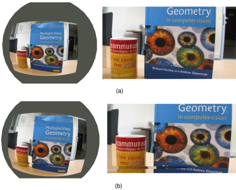
FIGURE 4.11 – Mosaïque sphérique multi-résolution de 5 images obtenues avec (a) Notre méthode (b) [115]. La colonne de gauche étant la vue sphérique complète et la colonne de droite un aperçu détaillé d'une région d'intérêt
