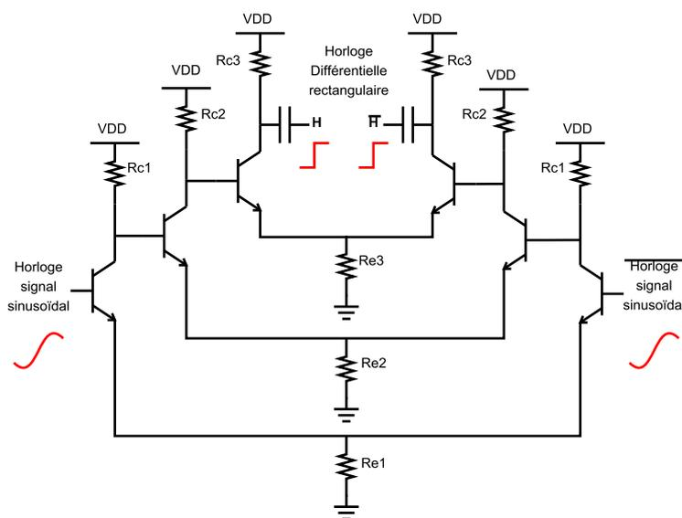
FIGURE 6.31 – Schéma pour la génération d'horloge
