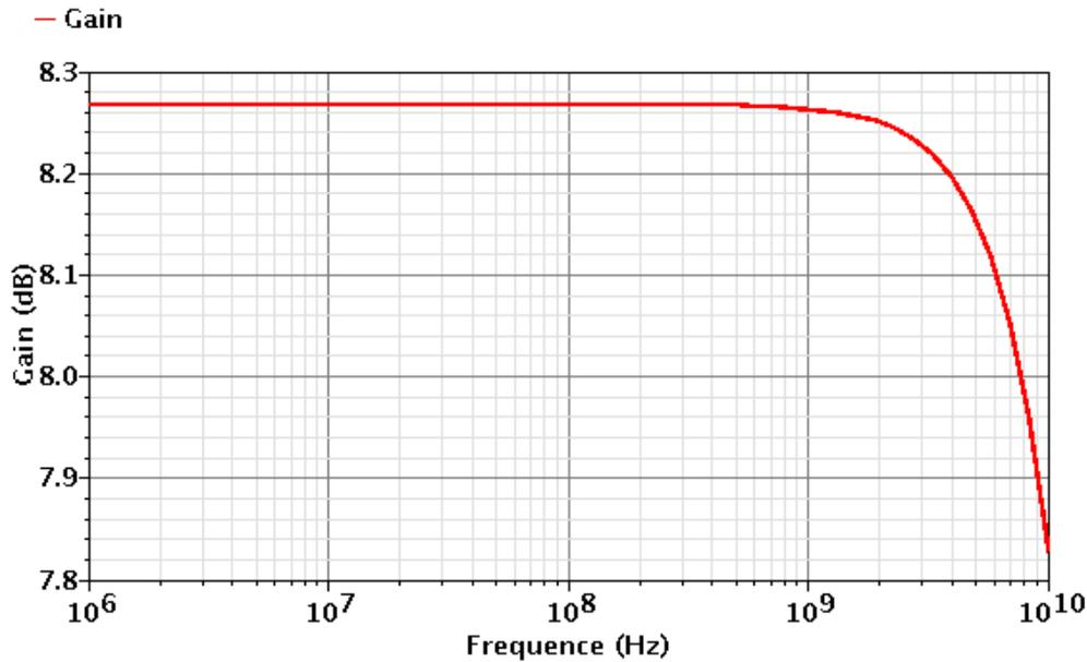
FIGURE 6.15 – Gain du pré-amplificateur obtenu en simulation
