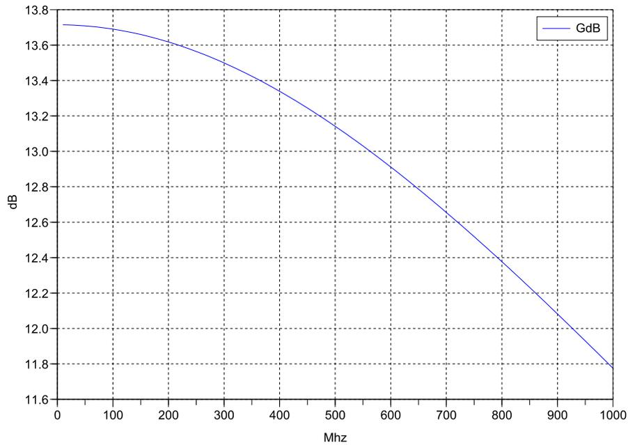
FIGURE 3.24 – Gain en régime linéaire du pré-amplificateur obtenu avec  $V_{dc_{Ref+}} = V_{dc_{Ref-}}$ ,  $I_d = 0,5mA$   $W = 2,1 \mu m$  et  $L = 0,25 \mu m$  avec un nombre de doigts d'émetteur égal à 8
