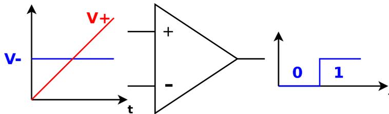
FIGURE 3.20 – Schéma de principe d'un comparateur
