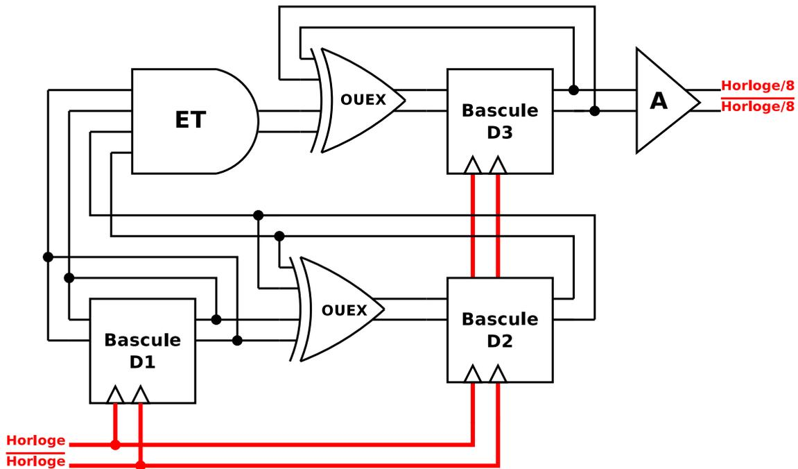
FIGURE 8.8 – Schéma du compteur modulo 8
