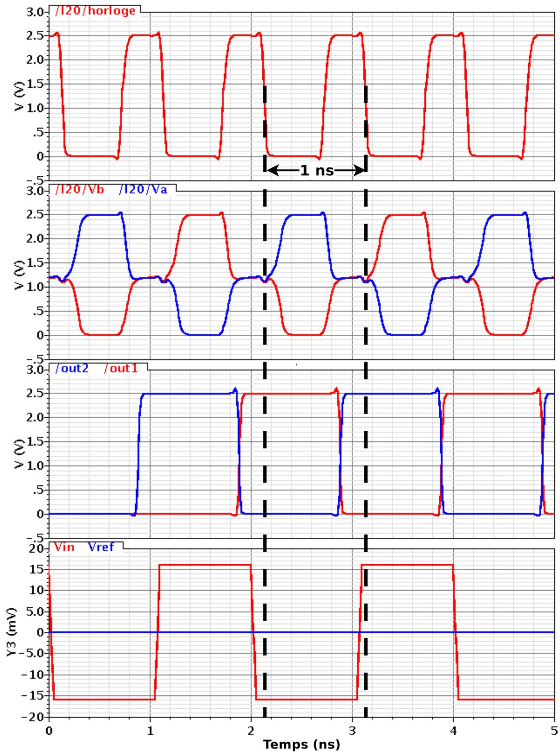
FIGURE 3.31 – Chronogramme des étages du comparateur utilisé
