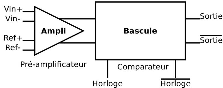
FIGURE 6.11 – Schéma de principe du comparateur
