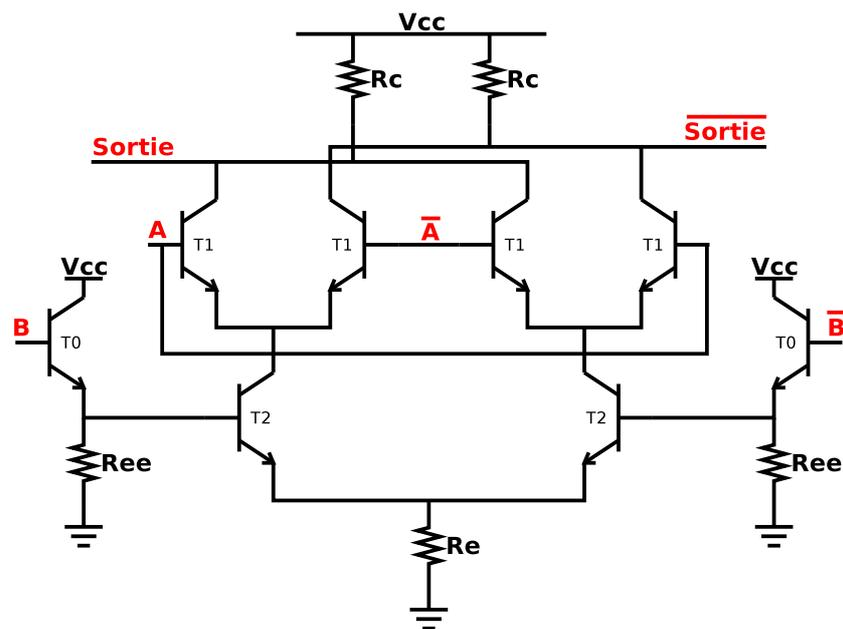
FIGURE 6.26 – Schéma électrique du OU exclusif
