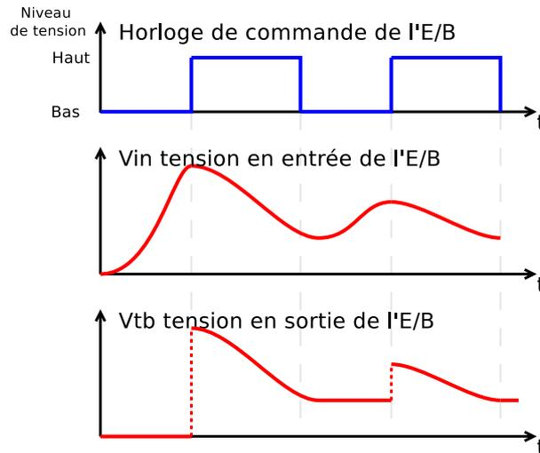
FIGURE 3.4 – Résultat temporel du E/B avec impédance de charge infinie
