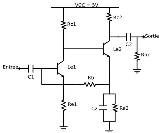
FIGURE 3.10 – Topologie d'amplificateur avec des transistors NPN
