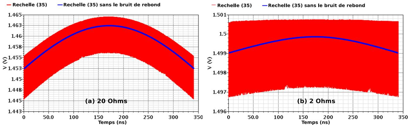
FIGURE 6.20 – Résultat temporel aux bornes d'une résistance pour une valeur de  $20\ \Omega$  en (a) et  $2\ \Omega$  en (b) pour une rampe injectée en entrée, la courbe bleue représente le signal sans bruit de rebond, la courbe rouge représente le signal réel
