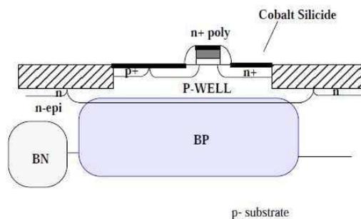
FIGURE 1.1 – Vue de coupe du transistor MOS
