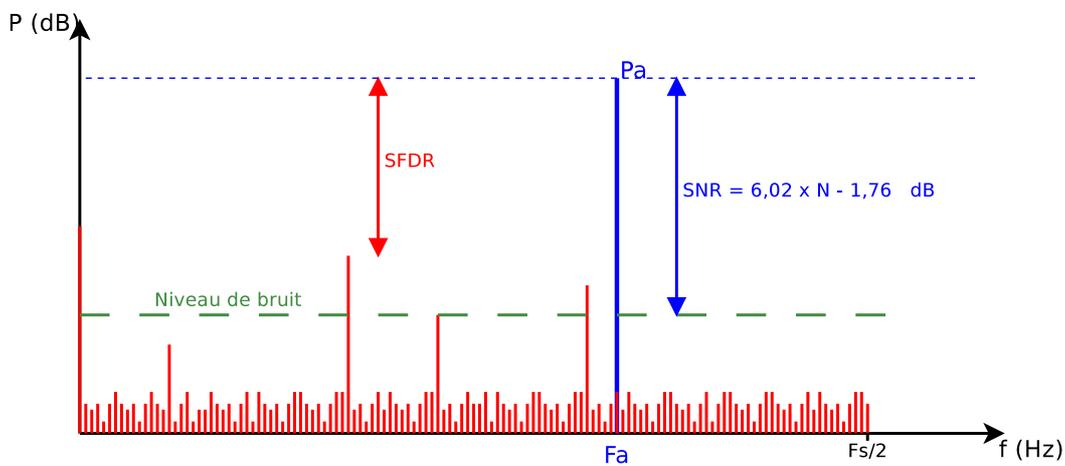
FIGURE 2.6 – Analyse Spectrale, description des résultats dynamiques
