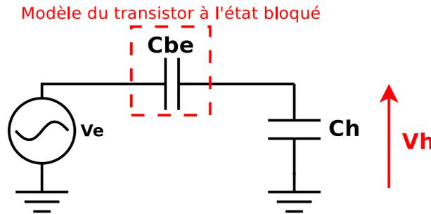
FIGURE 6.3 – Modèle simplifié en mode bloqué
