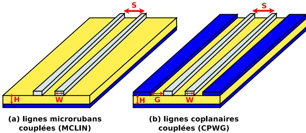
FIGURE 8.11 – Schéma des lignes utilisées : (a) lignes microrubans couplées et (b) lignes coplanaires couplées
