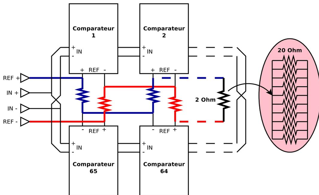
FIGURE 7.5 – Echelle résistive avec une connexion entrelacée
