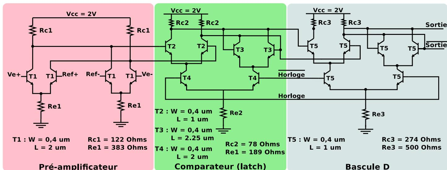
FIGURE 6.18 – Schéma électrique du comparateur bipolaire
