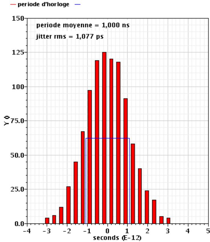
FIGURE 3.47 – Jitter de l'horloge
