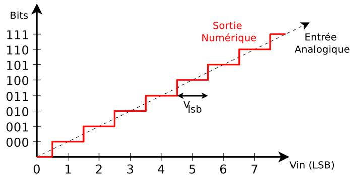
FIGURE 2.2 – Fonction de transfert du CAN
