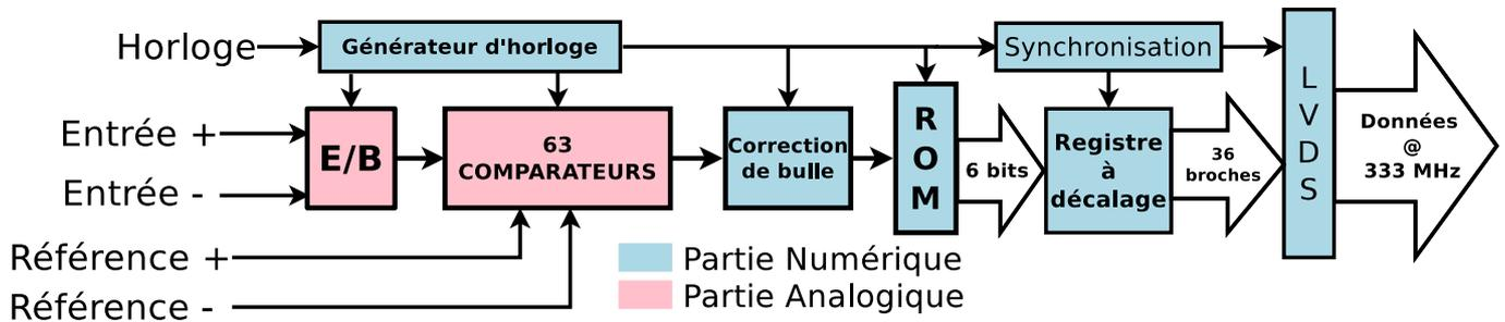
FIGURE 3.51 – Schéma du CAN complet
