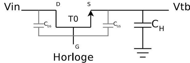
FIGURE 3.3 – Echantillonneur-bloqueur idéal en technologie MOS
