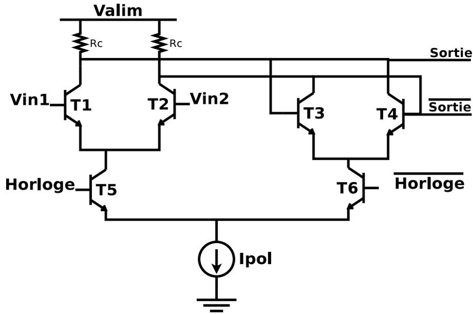
FIGURE 6.16 – Schéma électrique du comparateur bipolaire
