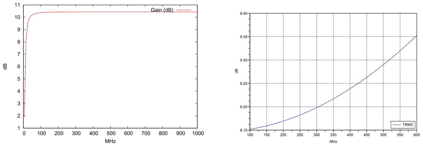
FIGURE 3.17 – A gauche, gain de la structure. A droite, le taux de réjection en mode commun
