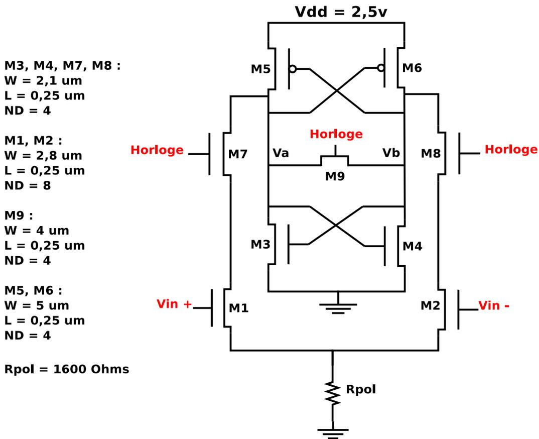
FIGURE 3.26 – Le comparateur à verrouillage proposé
