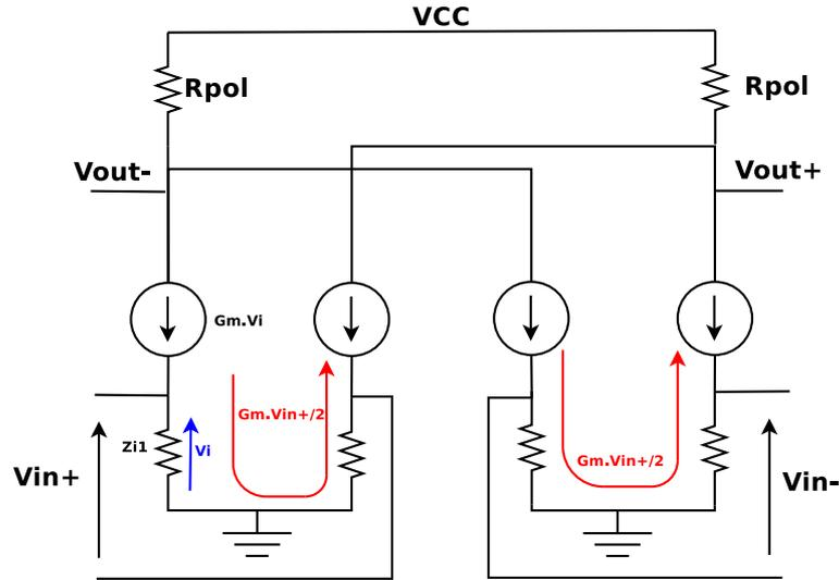
FIGURE 3.22 – Schéma équivalent petits signaux du pré-amplificateur
