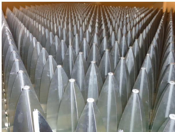
FIGURE 4 – Une tuile composée d'antennes Vivaldi avec commandes intégrées
