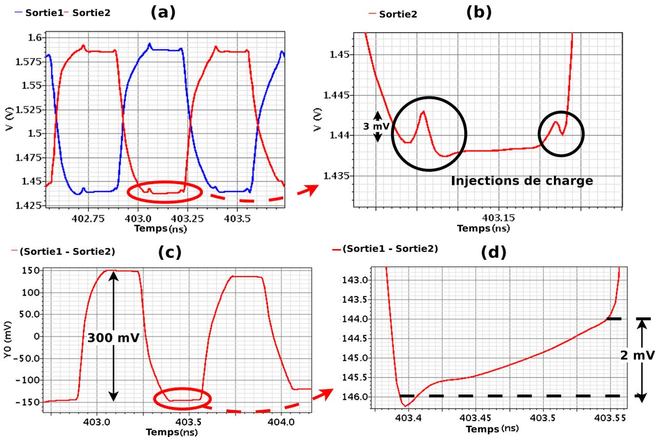
FIGURE 6.10 – Simulation temporelle en pleine échelle ( $E_g = 500$  mV) avec la fréquence d'entrée égale à 1,4 GHz et une fréquence d'horloge égale à 3 GHz avec en : (a) les sorties temporelles de l'E/B, (b) le zoom sur un état bloqué d'une des sorties de l'E/B, (c) les sorties différentielles de l'E/B, (d) le zoom sur un état bloqué de la sortie différentielle
