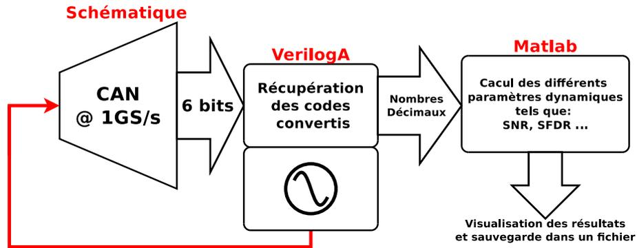
FIGURE 3.54 – Schéma de la mesure dynamique
