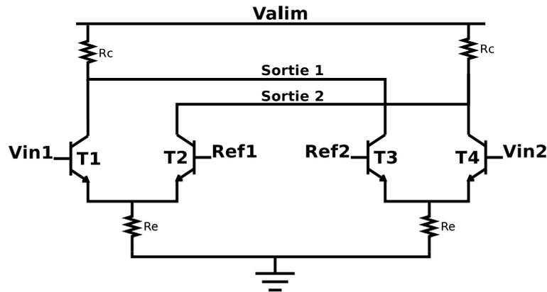
FIGURE 6.13 – Schéma électrique du pré-amplificateur bipolaire
