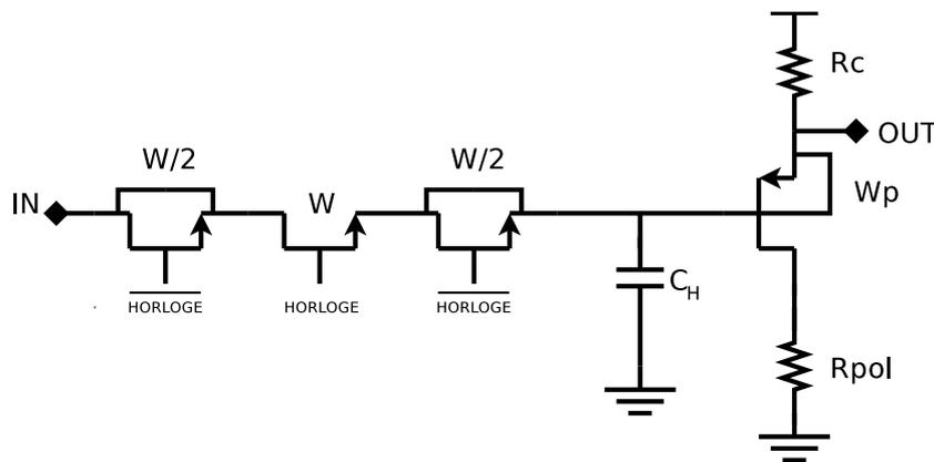
FIGURE 3.6 – Echantillonneur Bloqueur en NMOS
