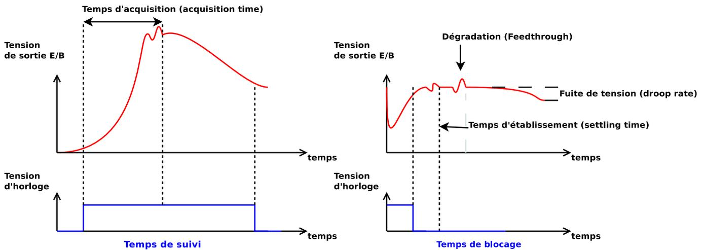
FIGURE 3.5 – Source d'erreurs en mode suivi et en mode bloquée
