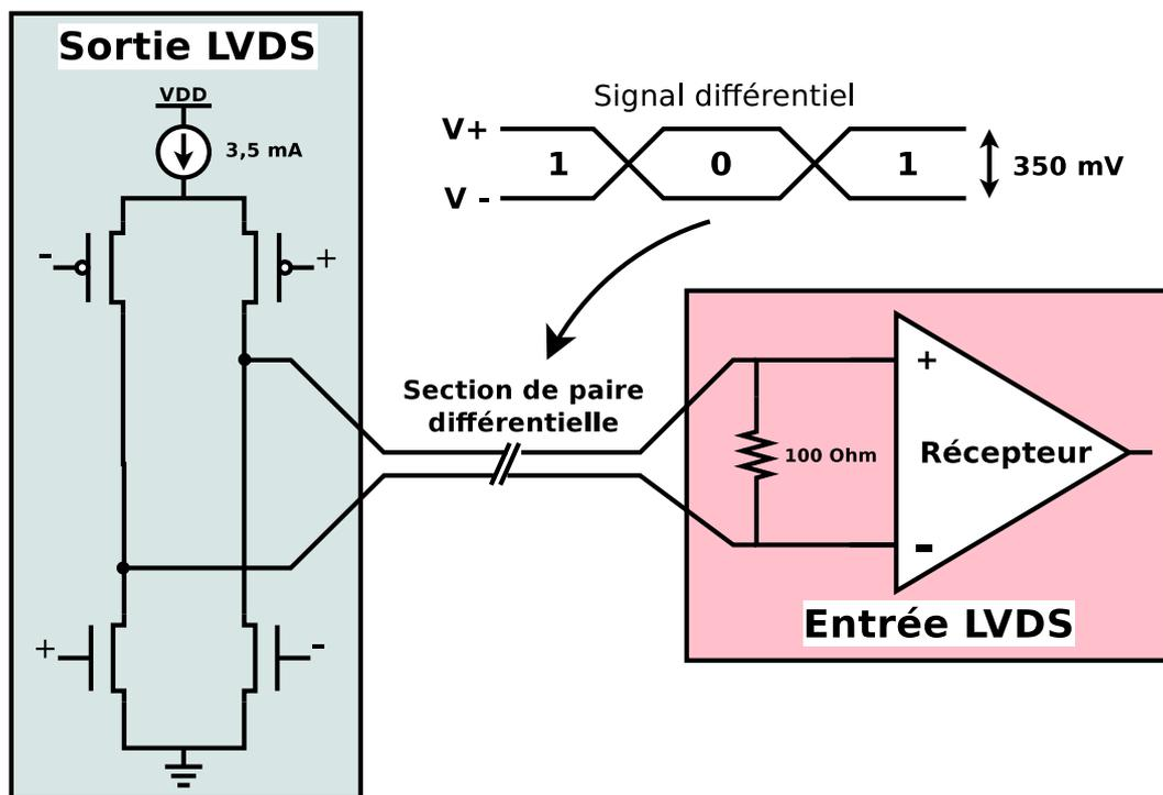
FIGURE 3.49 – Schéma LVDS en émission et réception
