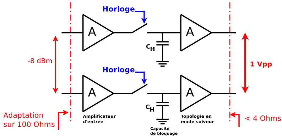
FIGURE 3.9 – Topologie E/B Boucle sans contre réaction
