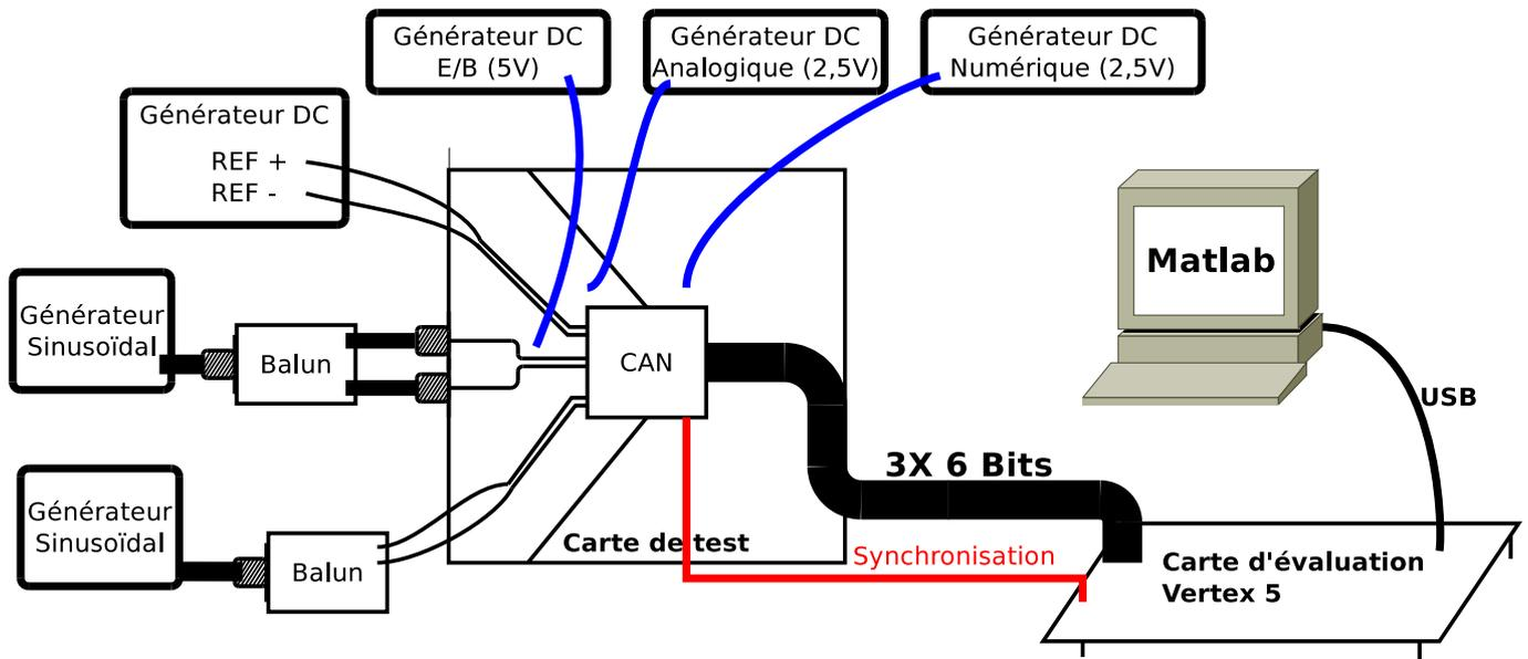
FIGURE 5.2 – Banc de test du CAN
