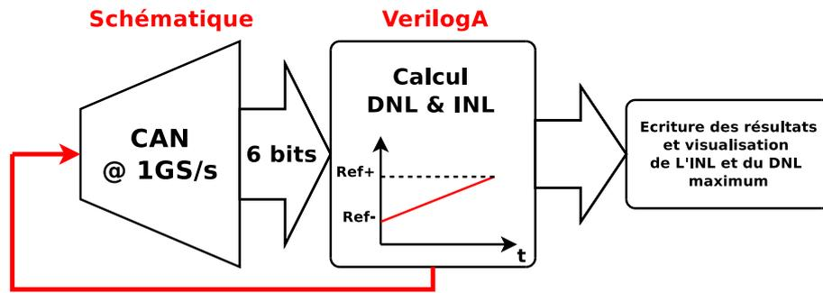
FIGURE 3.52 – Schéma du test INL et DNL
