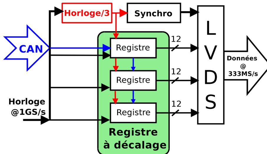
FIGURE 3.40 – Système de test en sortie du CAN
