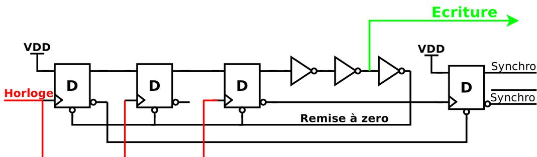
FIGURE 3.42 – Synchronisation et validation d'écriture pour le registre à décalage
