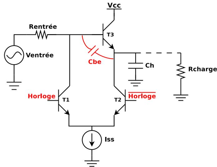
FIGURE 6.2 – Schéma de l'émetteur suiveur commuté (SEF)
