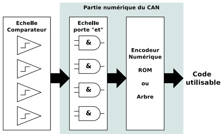
FIGURE 3.33 – Schéma de la structure numérique
