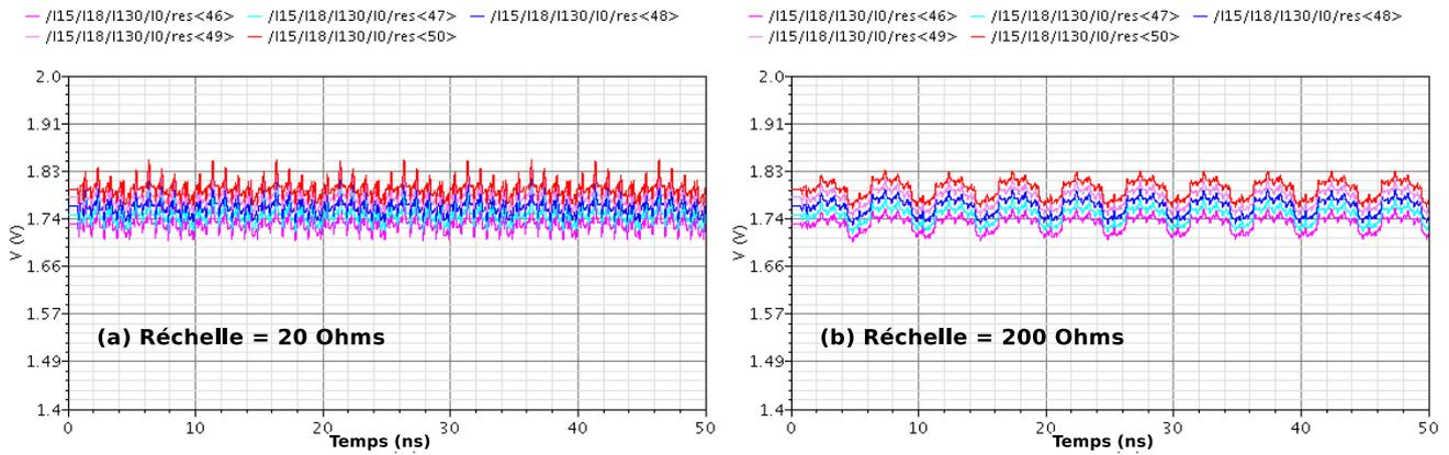
FIGURE 3.32 – Tensions de référence, pour  $F_{\text{echantillonnage}} = 1\text{GS/s}$  et  $F_{\text{entree}} = 100\text{ MHz}$ , avec en (a)  $R_{\text{echelle}} = 20\ \Omega$  et (b)  $R_{\text{echelle}} = 200\ \Omega$
