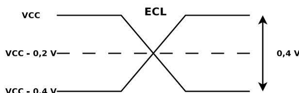
FIGURE 5.4 – Niveaux logiques de la norme ECL
