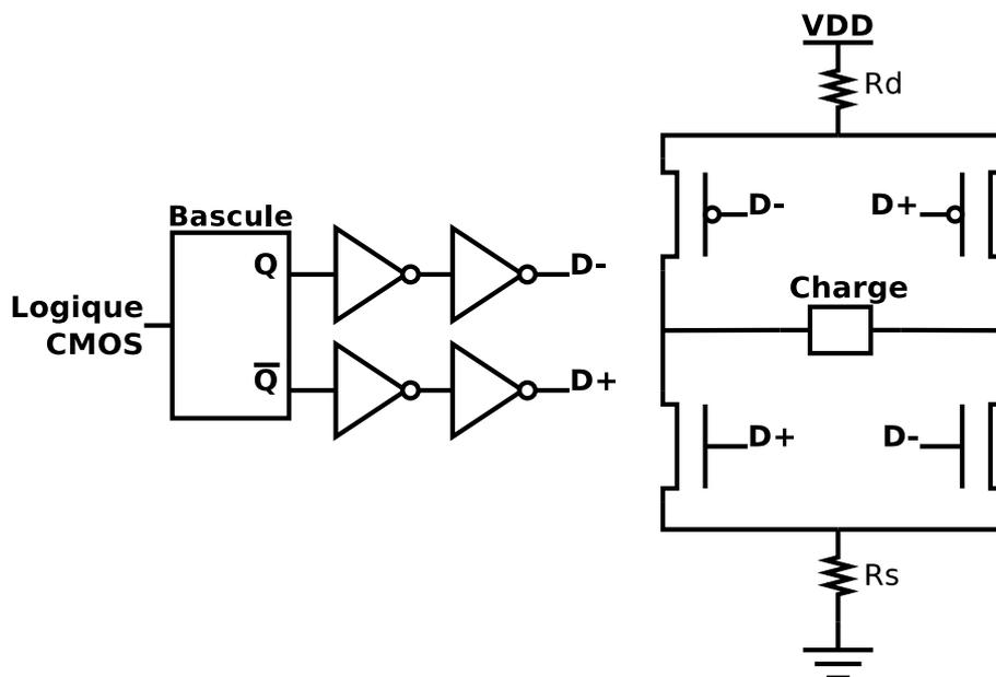
FIGURE 3.50 – Schéma de la sortie LVDS utilisée
