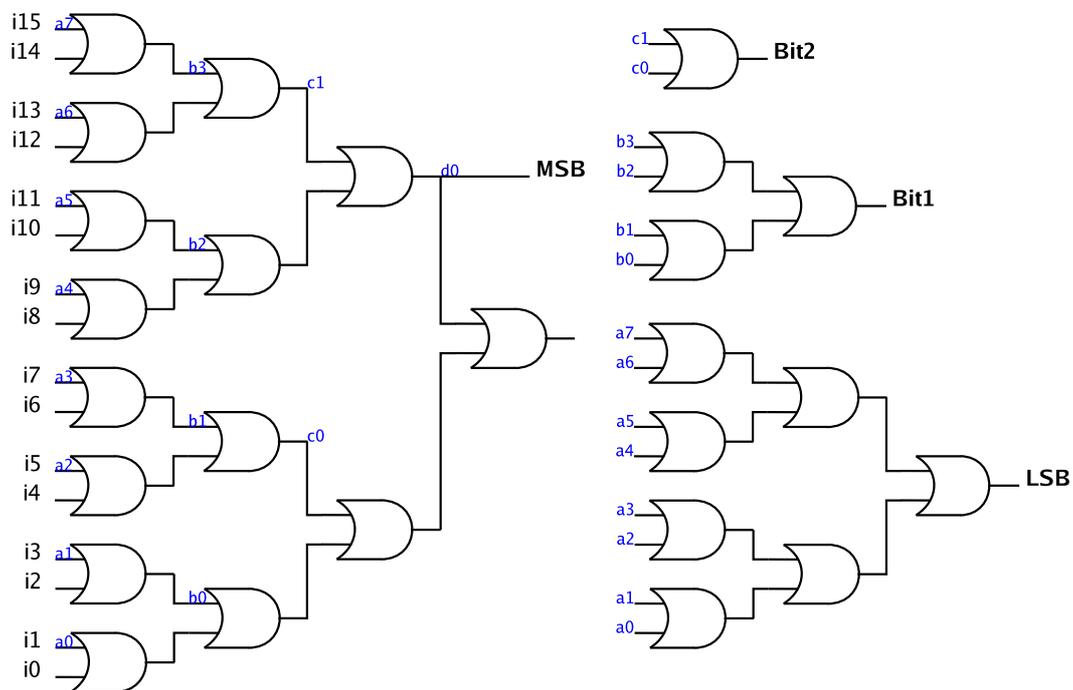
FIGURE 6.21 – Schéma du décodeur pour une architecture 4 bits
