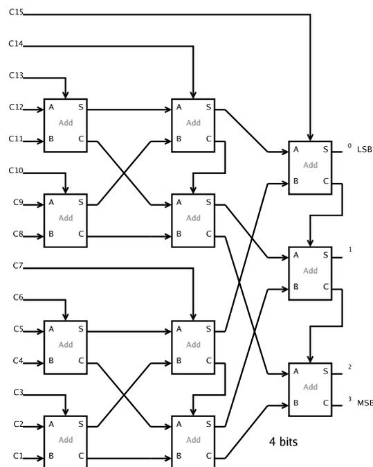
FIGURE 3.35 – Décodeur à arbre avec additionneur pour un CAN flash 4 bits
