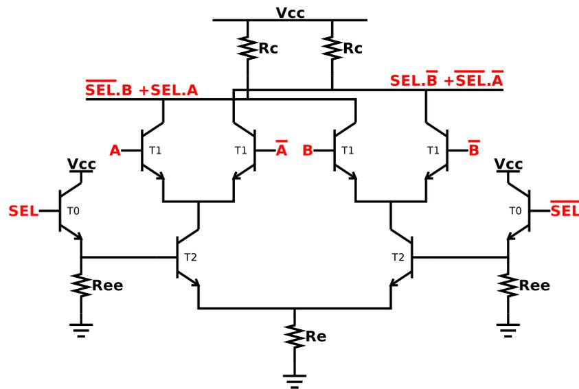
FIGURE 6.25 – Schéma électrique du démultiplexeur 2 vers 1
