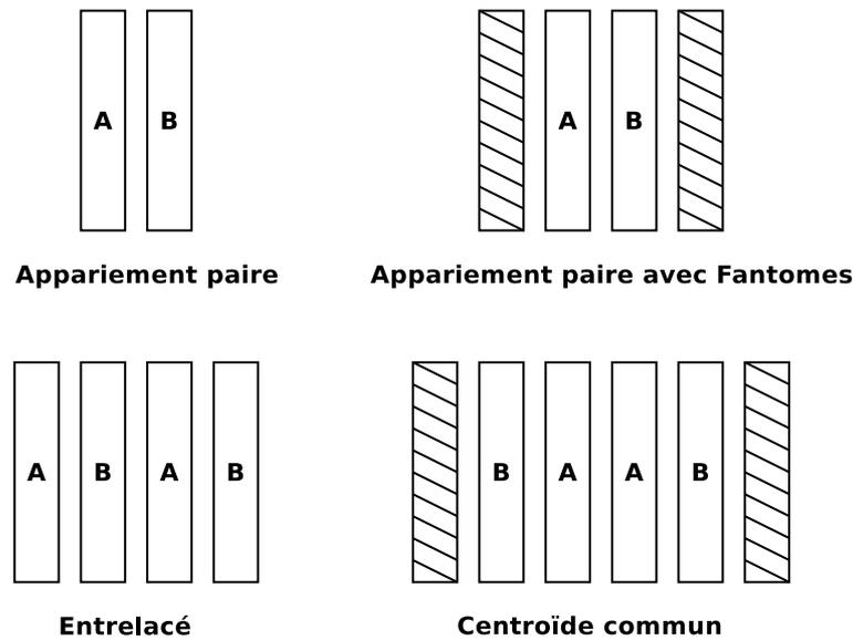
FIGURE 4.4 – Les différentes techniques d'appariement des résistances
