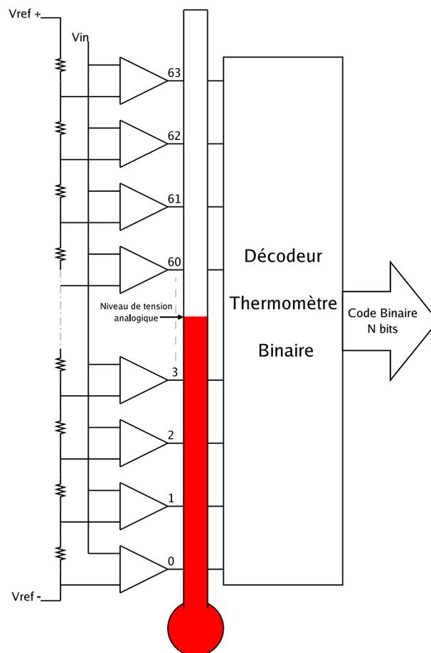
FIGURE 2.9 – Structure de l'ADC Flash
