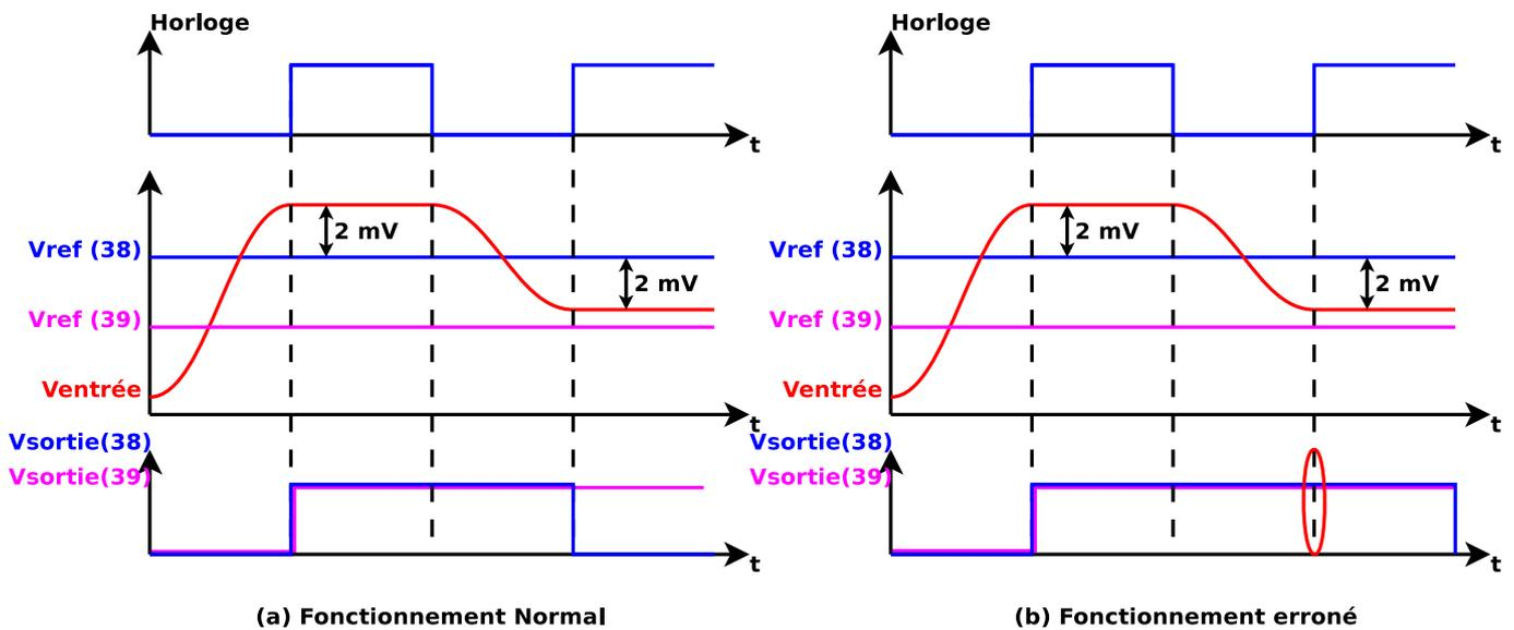
FIGURE 6.17 – Chronogramme du fonctionnement normal en (a) et du fonctionnement erroné en (b)
