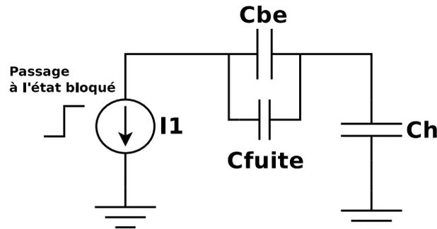
FIGURE 6.5 – Modèle simplifié pour l'erreur du piédestal
