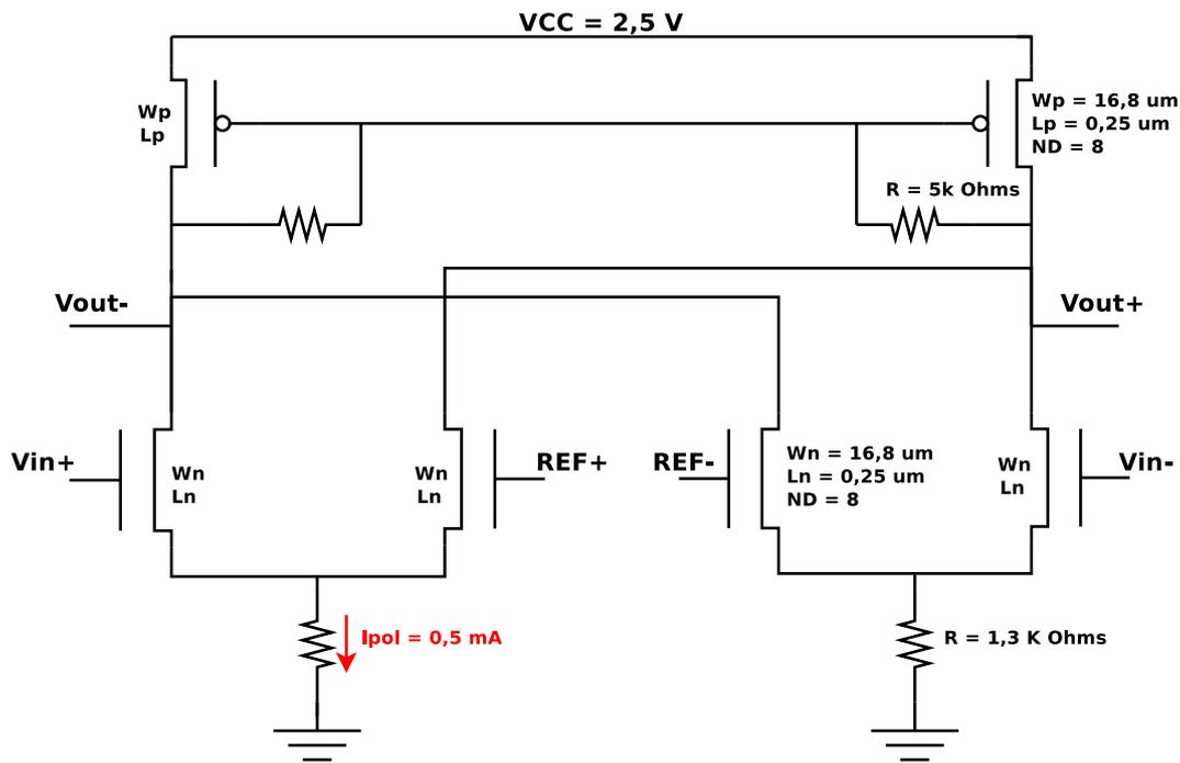
FIGURE 3.23 – Schéma électrique final du pré-amplificateur
