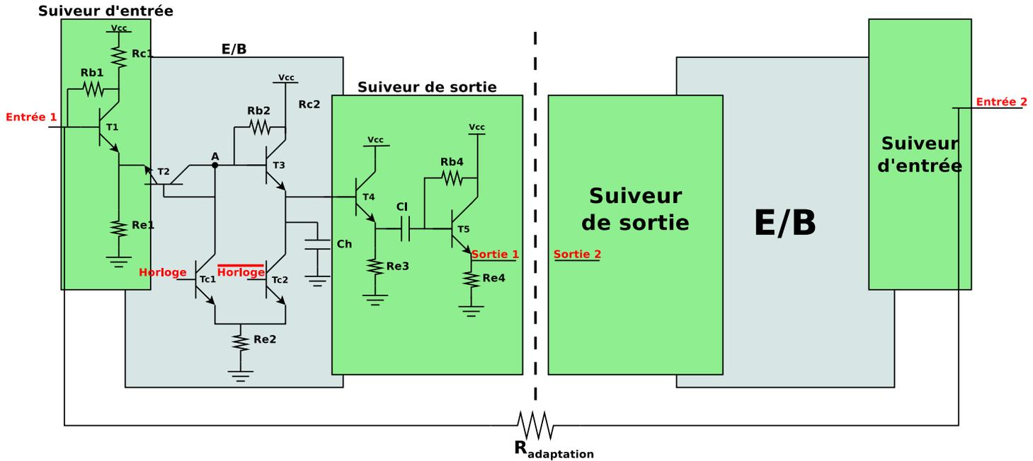
FIGURE 6.6 – Schéma réalisé de l'E/B différentiel
