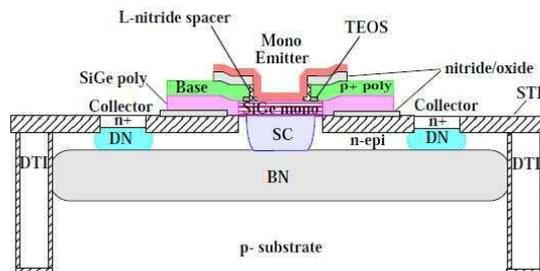
FIGURE 1.2 – Vue de coupe du transistor Bipolaire
