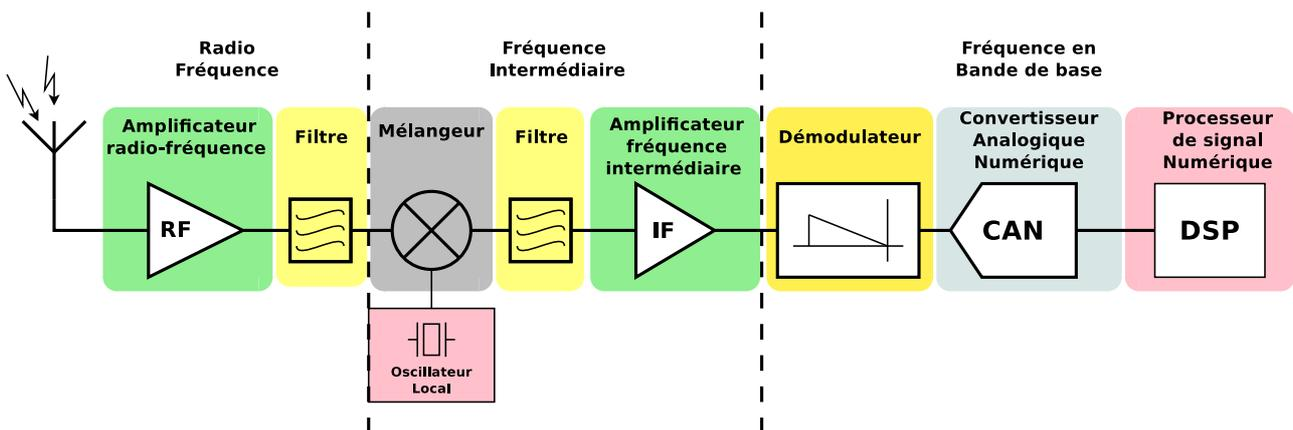
FIGURE 5 – Diagramme récepteur superhétérodyne
