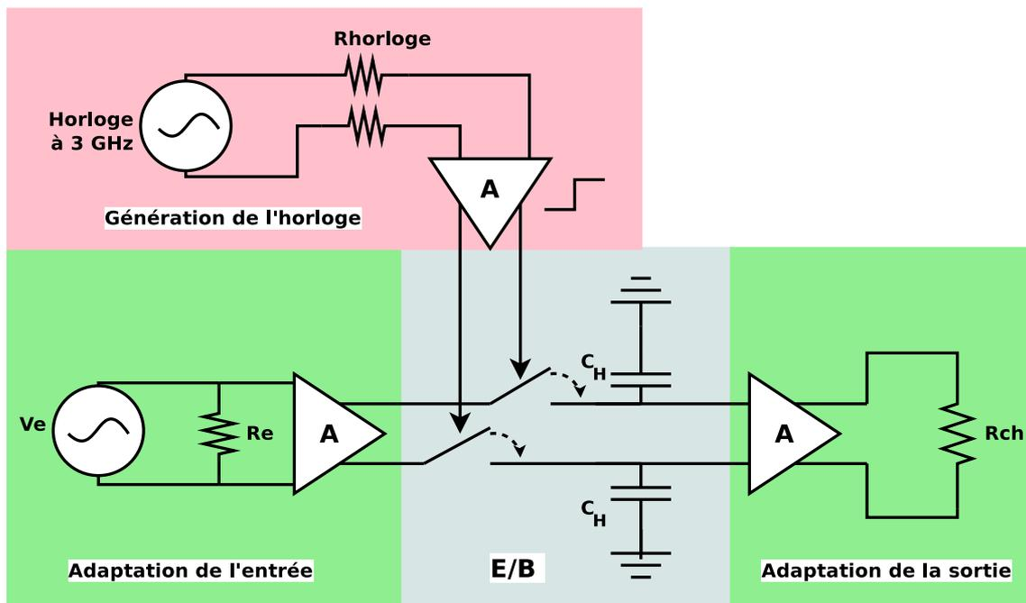
FIGURE 6.1 – Schéma de principe de l'E/B avec prise en compte de la génération d'horloge
