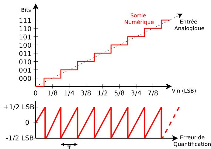
FIGURE 2.3 – L'erreur de quantification d'une entrée à rampe
