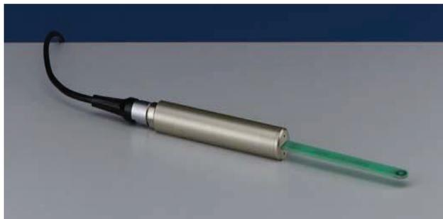
Figure 1.16 : Sonde inductive utilisée par un gaussmètre Brockhaus [63]
