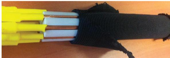
Figure 4.21 : Câble aux caractéristiques connus de huit conducteurs
