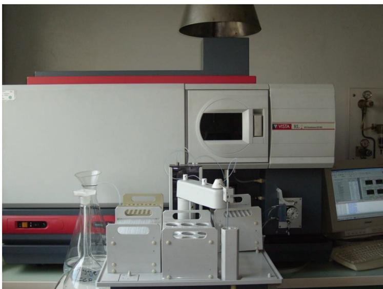
**Figure 17.** ICP-OES Vista-Pro ayant servi aux mesures
