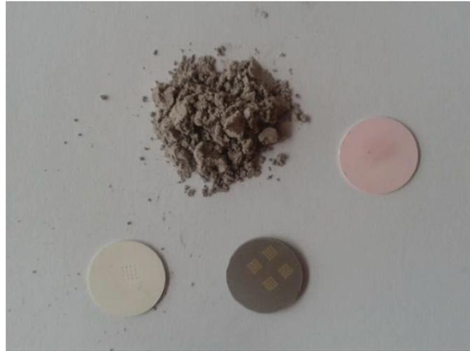
**Figure 24.** Pastilles utilisées pour l'analyse des terres rares en LIBS
