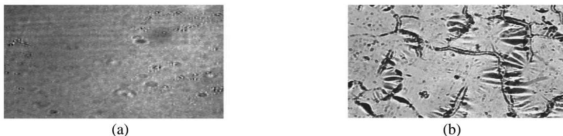
**Figure 96.** Dégradations surfaciques de la résine EBA après exposition aux UV ( $30 \text{ mW/cm}^2$ ) [174]
