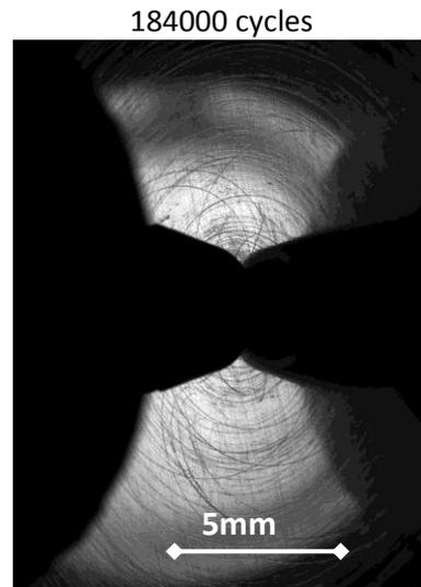
LISN743A-D (0,9mm) arrêt de l'essai au bout de  $1,8 \cdot 10^6$  cycles → pas d'amorçage de fissure
