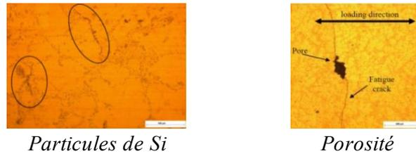
Figure I. 24. Emplacement de l’amorçage de fissure [23]
