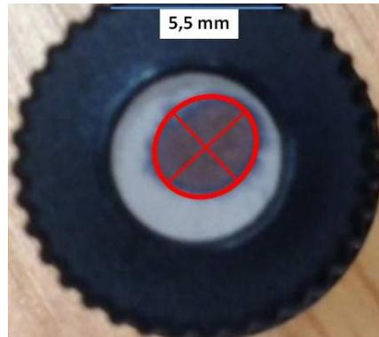
**Figure 5-8 :** Photographie du papier marquant après irradiation du laser. L'ellipse permet de mesurer précisément la surface du faisceau.
