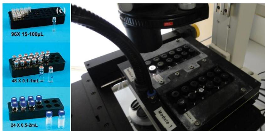
**Figure 5-4 :** Dispositif expérimental utilisé au CINaM pour étudier la limite de zone métastable. Les modules permettent d'étudier de 24 à 96 tubes suivant l'ampleur de la statistique souhaitée ou de la disponibilité du soluté et du solvant (gauche). Les deux modules sont montés sur une plaque mobile horizontalement dans deux directions. L'ensemble est contrôlé en température et un programme LABVIEW gère le déplacement de la table porte échantillon, la vitesse de refroidissement et la caméra.
