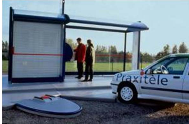
Figure 2: Recharge de la batterie sans fil VE PRAXITELE utilisant le paiement de la facturation électrique
