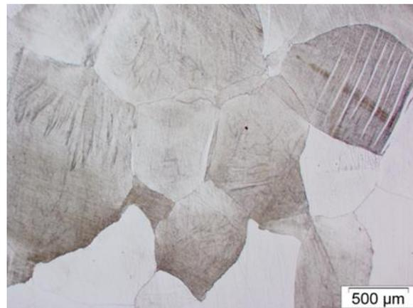
Figure V-1 : Coupe métallographique de l'alliage Fe15Cr en sens transverse au laminage après recuit 700°C pendant 2h suivi d'une trempe à l'eau
