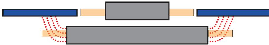
Figure A1-4. Flux de fuites 3D au niveau des plaques de blindage
