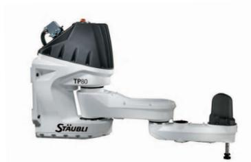
(c) Staubli - Robot TP80 Fast Picker - cycle ADEPT en 308 ms, répétabilité  $< \pm 0,05$  mm
