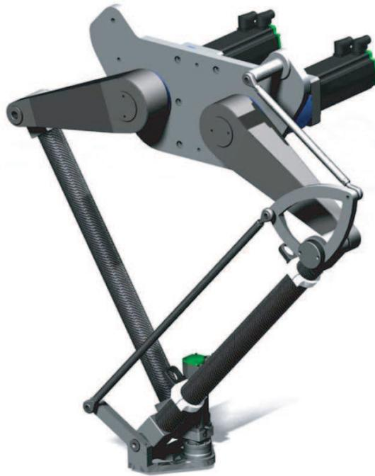
Figure 1.12 – Robot PacDrive D2 par Schneider [Schneider Electrics, 2013]
