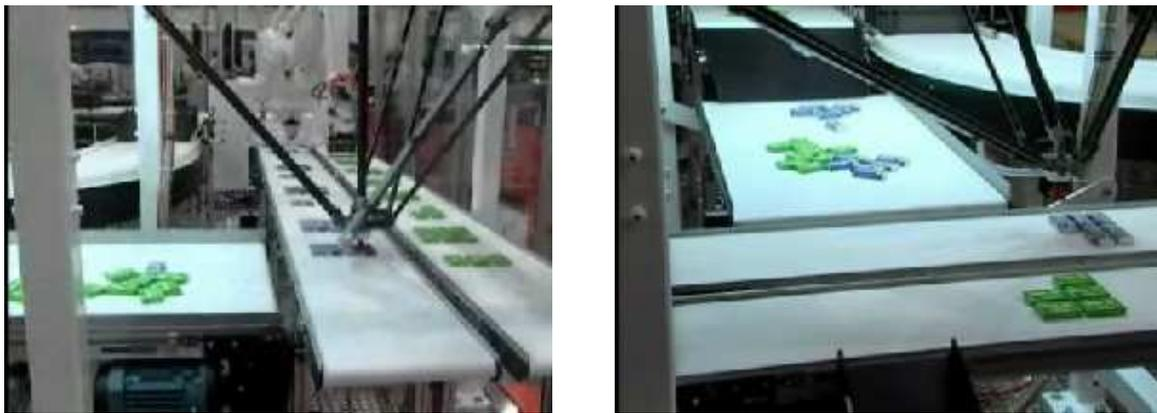
Figure 1.3 – Mécanisme 3T1R de tracking et orientation
