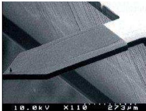
Figure 1-14 : Image MEB d'une pointe AFM sur son levier. Pointes standards commercialisées par Nanoandmore<sup>a</sup>
