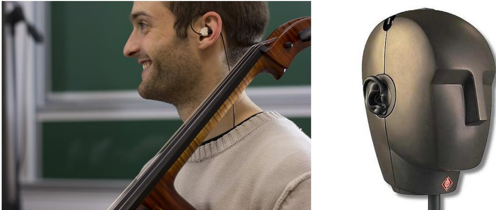
FIGURE 1.13 – (Gauche) Enregistrement binaural par microphones DPA, situés à l’embouchure du conduit auditif d’un joueur de violoncelle. (Droite) Tête artificielle Neumann KU100, avec microphones intégrés au creux de chaque "oreille". (source [www.neumann.com](http://www.neumann.com))
