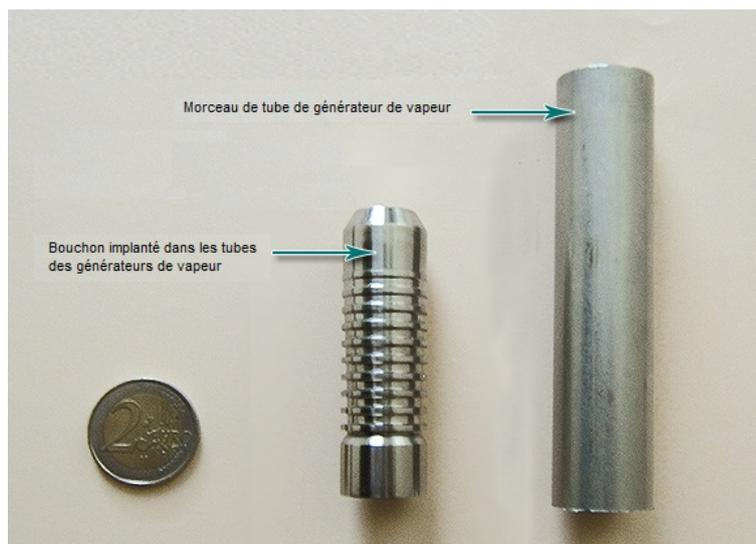
FIGURE 1.3 – Photo de bouchon de tube générateur de vapeur - *Source : <http://www.asn.fr>*
