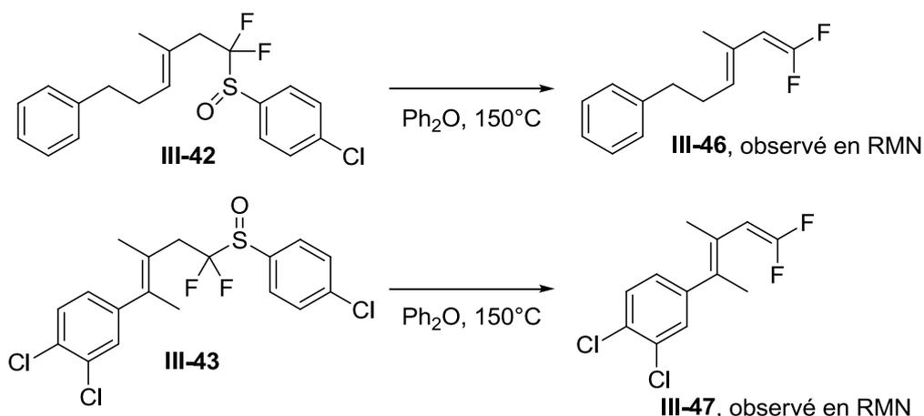
Aucun produit n'ayant été isolé, nous n'avons pas pu établir de rendements pour ces deux réactions. Cependant, la conversion complète observée par RMN tend à confirmer le fait que la réaction d'élimination permettant d'obtenir les diènes difluorés est efficace et rapide. Nous n'avons malheureusement pas eu le temps nécessaire pour préparer de nouveaux substrats, ce qui aurait permis de mieux cerner l'étendue et les limites de cette méthode.
