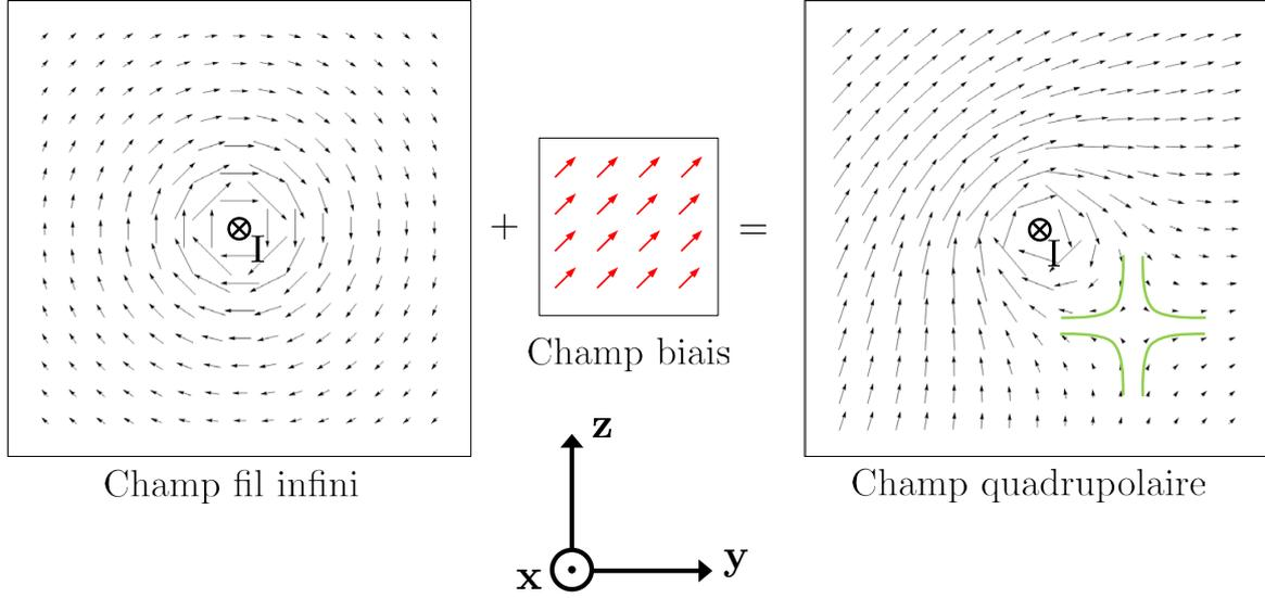
FIGURE II.4 – Le champ magnétique créé par un fil infini, parcouru par un courant dans le sens  $-x$  combiné avec un champ de biais sur une direction perpendiculaire au fil. Le champ s'annule à l'endroit où le champ de biais compense le champ créé par le fil. Autour du zéro le champ magnétique est quadrupolaire. Quelques lignes de champ sont dessinées en vert pour l'indiquer.
