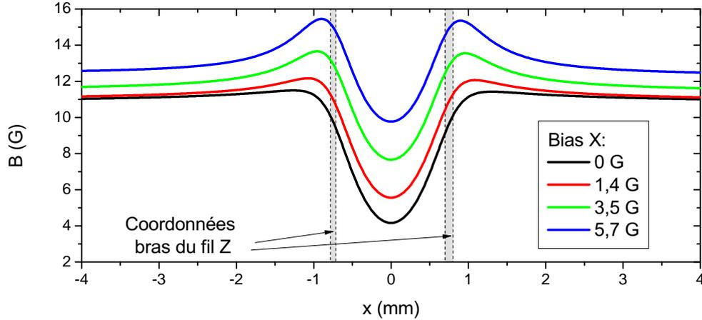
FIGURE II.5 – Champ magnétique du piège de Ioffe-Pritchard sur la direction  $x$ , autour du centre du piège. Ce champ est créé par un courant dans le fil Z plus un champ de biais selon  $z$ . Les différents champs de biais  $B_{0x}$  s'ajoutent à la valeur du minimum et diminuent la raideur du piège. Pour ce calcul,  $B_{0y} = 0$  et  $B_{0z} = 11$  G.
