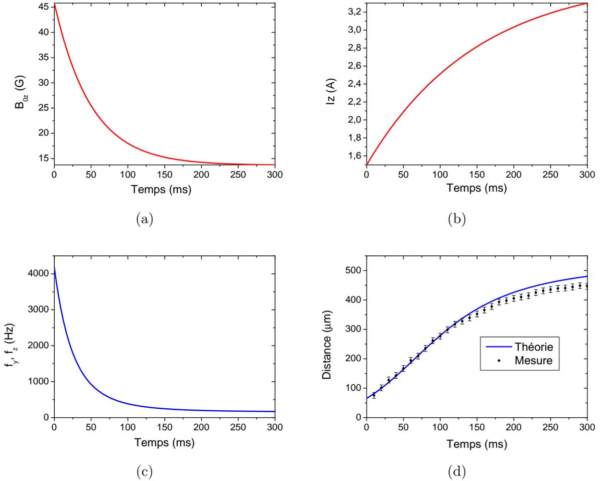
FIGURE D.1 – (a), (b) : rampes de champ de biais  $B_{0z}$  et de courant  $I_z$  pour la décompression du piège magnétique après évaporation. (c), (d) : fréquences de piégeage sur la direction  $y$  et  $z$ ,  $\omega_{\perp}/(2\pi)$ , et distance à la puce, calculées à partir des formules (II.10) et ((II.5)). La distance mesurée est aussi montrée en points noirs.
