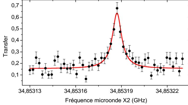
FIGURE III.15 – spectre de la transition à deux photons  $|60S_{1/2}, m_J = 1/2\rangle \rightarrow |61S_{1/2}, m'_J = 1/2\rangle$ . La courbe en rouge est un ajustement Lorentzien. La forme exacte de la courbe est fonction de la distribution de champs électriques et de la densité atomique dans l'espace, et du bruit de tension sur les électrodes.
