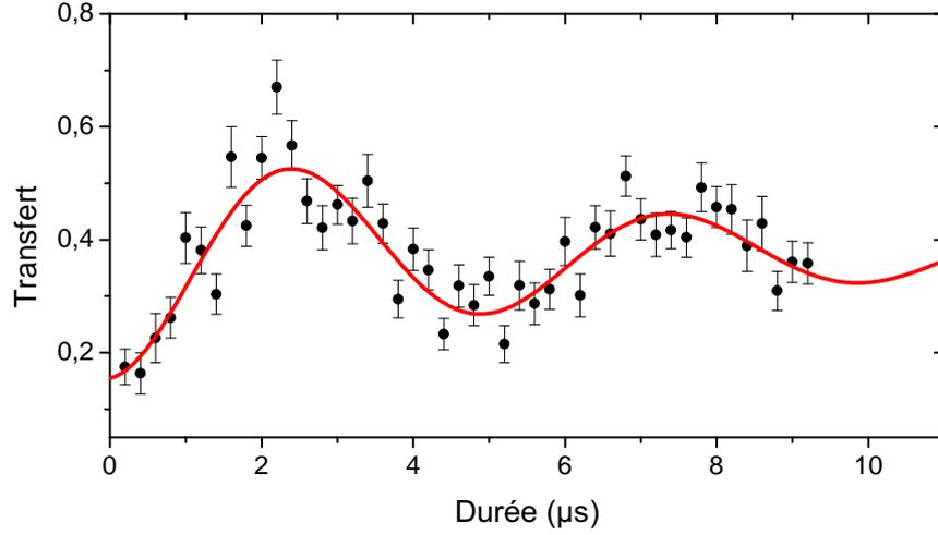
FIGURE IV.11 – Taux de transfert  $60S \rightarrow 57S$  comme fonction de la durée de l’impulsion micro-onde, fait dans un piège peu dense, montrant des oscillations d’amplitude de Rabi. A l’aide de ces courbes nous échelonnons la fréquence de Rabi créé par la puissance micro-onde envoyée par les fenêtres du cryostat.
