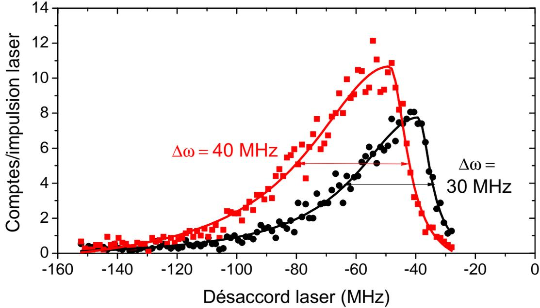
FIGURE III.9 – Deux spectres autour de la transition  $5S \rightarrow 60S$ , avant le travail de correction de la dérive et l’inhomogénéité des champs électriques dans le cryostat. Leur largeur est de 30 et 40 MHz, et leur centre diffère de 12 MHz. Ils ont été faits à 1 h d’écart l’un de l’autre ; pendant ce temps, un MOT était piégé devant la puce.
