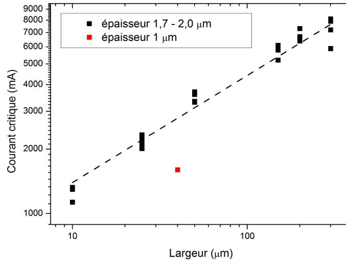
FIGURE A.2 – Mesures de courant critique pour des échantillons d'épaisseur entre 1,7 et 2  $\mu\text{m}$ . Un ajustement pour une dépendance à la largeur en racine carré est montré en pointillés, de coefficient  $441 \text{ A}\mu\text{m}^{-1/2}$ . Le courant critique de l'ancienne puce, d'épaisseur 1  $\mu\text{m}$ , est aussi indiqué.
