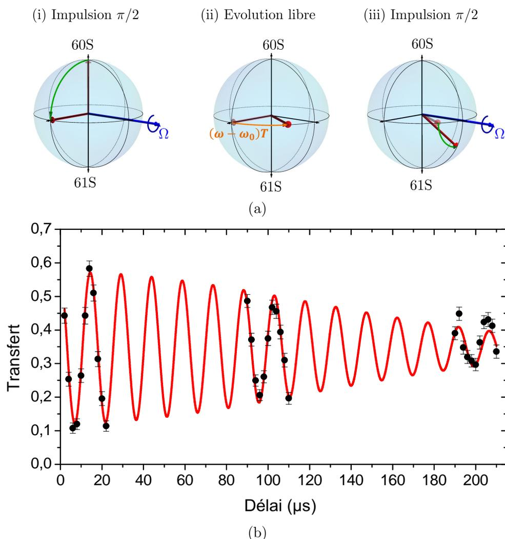
FIGURE III.16 – (a) : schéma de l’interférométrie Ramsey. (b) : résultat de la mesure projective de l’état de l’atome comme fonction du temps  $T$  d’évolution libre. Le temps de décohérence des oscillations est de  $163 \mu\text{s}$ , mesuré à partir d’un ajustement d’une sinusoïdale avec une enveloppe Gaussienne.
