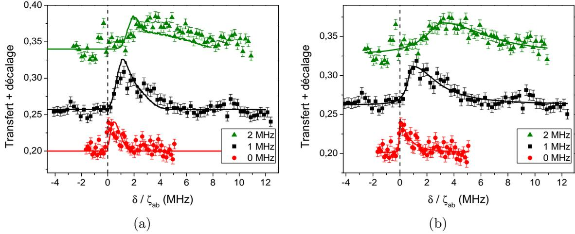
FIGURE IV.13 – Transition  $60S \rightarrow 57S$  à plusieurs désaccords de l'excitation laser. Les spectres expérimentaux sont indiqués par les points, avec leurs barres d'erreur qui indiquent la dispersion des mesures. (a) : Les courbes en trait plein sont calculées par la simulation Monte Carlo. (b) : Les courbes en trait plein sont des ajustements d'un profil Lorentzien asymétrique, qui calcule le centre et la largeur des spectres.
