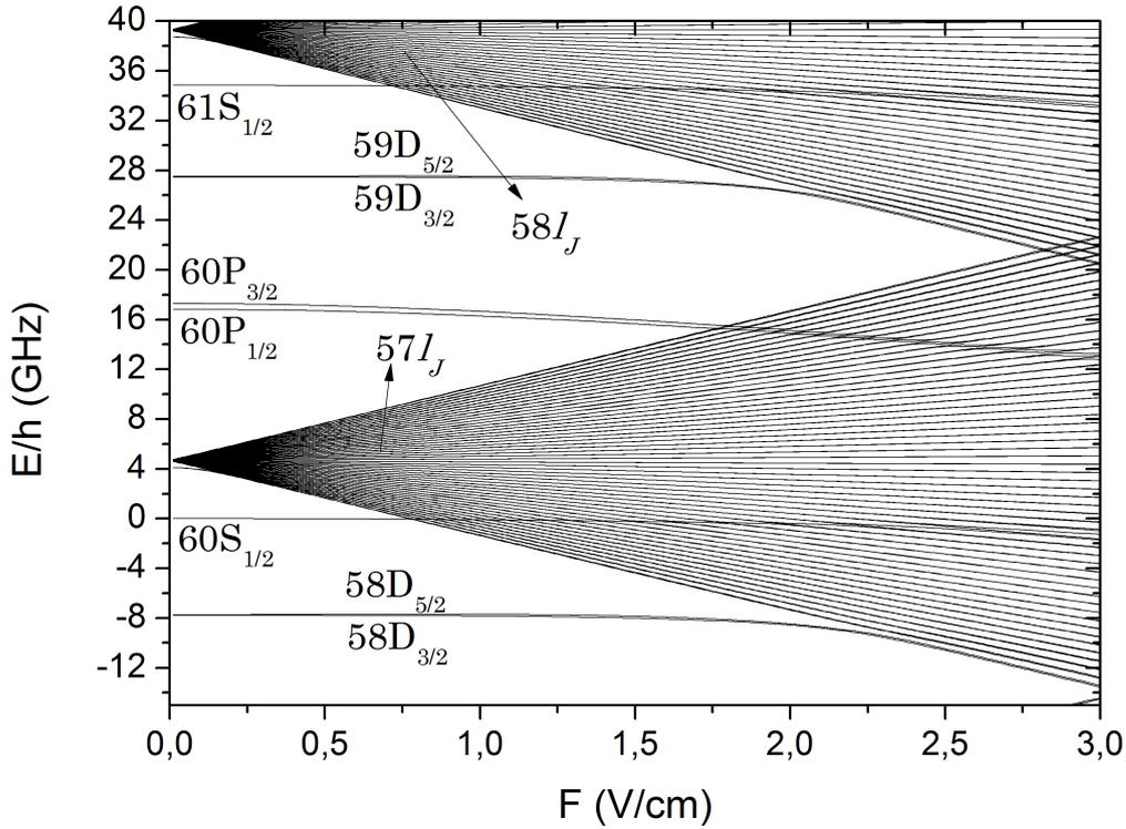
FIGURE III.10 – Diagramme Stark autour du 60S, pour les états de nombre magnétique  $m_J = 1/2$ . Le défaut quantique change l'énergie propre des niveaux S, P et D, en absence de champ électrique, par rapport à l'énergie des états de même  $n$  et grand  $l$ . Ces niveaux non-dégénérés ont un effet Stark quadratique pour des petits champs électriques. Les niveaux à grand  $l$  sont dégénérés et présentent un effet Stark linéaire (ce sont les multiplicités qui s'ouvrent en éventail).
