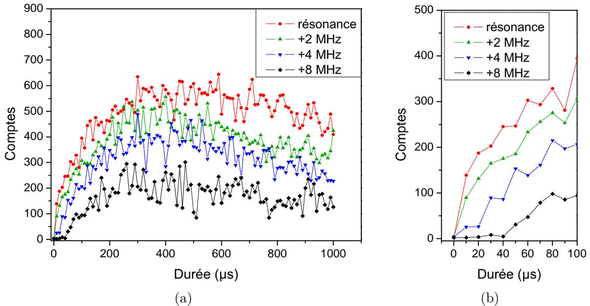
FIGURE IV.20 – Courbes d'excitation  $5S \rightarrow 60S$  comme fonction de la durée de l'impulsion laser, pour différents désaccords. La densité du nuage au centre est de  $2,6 \times 10^{11} \text{ cm}^{-3}$ . Le graphique (b) montre le détail du graphique (a) pour les durées courtes.
