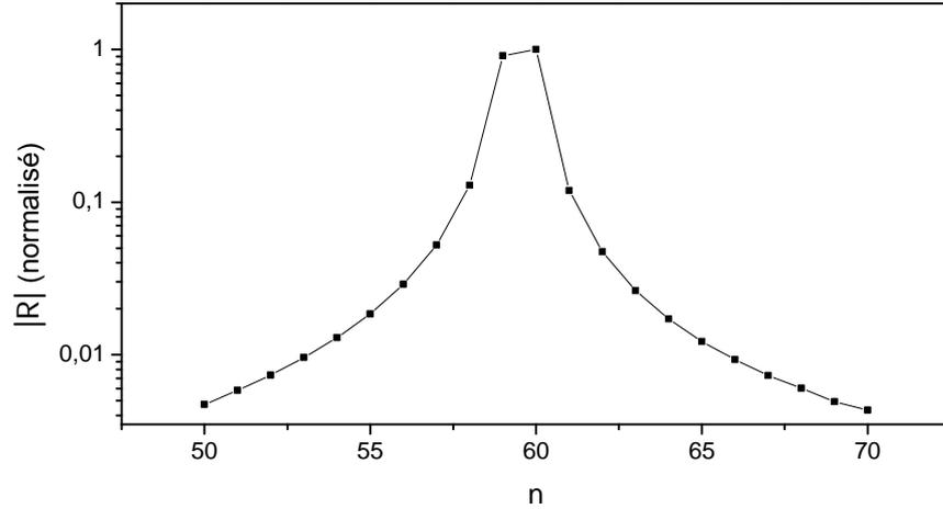
FIGURE I.3 – Partie radiale de l’opérateur de transition dipolaire électrique entre les niveaux  $|nP_{1/2}\rangle$  et  $|60S_{1/2}\rangle$ , normalisés à la valeur pour  $n = 60$ , en échelle logarithmique. Ces éléments de matrice deviennent négligeables dès que les nombres quantiques principaux des niveaux sont différents de quelques unités.
