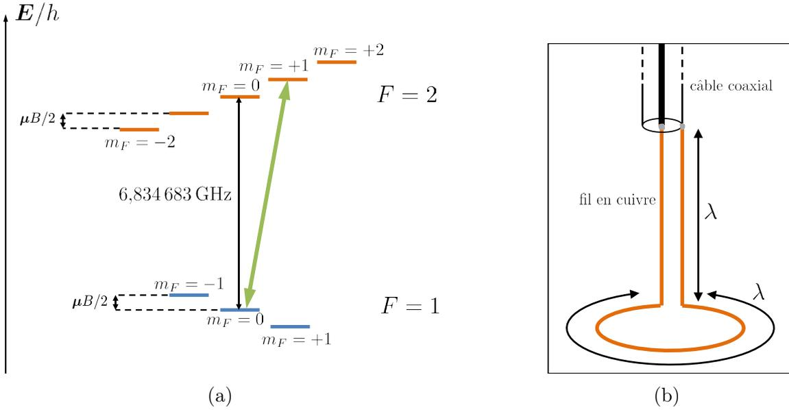
FIGURE II.15 – (a) : schéma des sous-niveaux Zeeman soumis à un champ magnétique de quelques Gauss. Le sous-niveau  $F = 1, m_F = +1$  est anti-piégeant, à cause du facteur de Landé négatif du niveau  $F = 1$ . La transition micro-onde d'évaporation des atomes dans le sous-niveau  $m_F = +1$  du  $F = 2$  est indiquée en vert. (b) : schéma de l'antenne micro-onde circulaire qui irradie la radiation à 6,8 GHz dans le cryostat.  $\lambda = 4,39$  cm.
