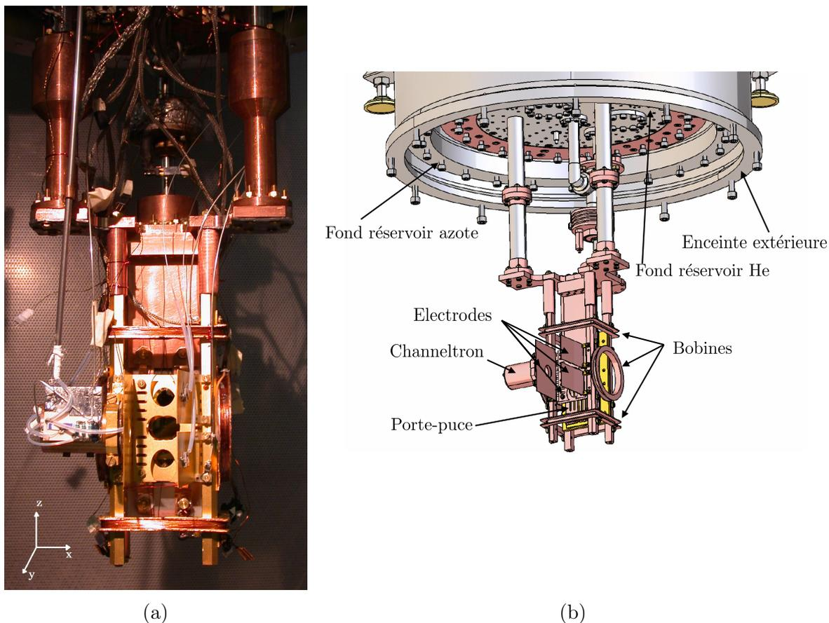
FIGURE II.2 – Photo et plan du coeur de l'expérience, attaché au bas du réservoir d' $^4\text{He}$ . Ses différents composants sont discutés dans le texte, ensemble avec la séquence expérimentale. Le porte-puce est la pièce mécanique sur laquelle la puce est attachée. Il manque, sur le plan et sur la photo, le dispenseur de rubidium utilisé pour faire un dépôt sur la surface de la puce, qui a été installé en dernier.
