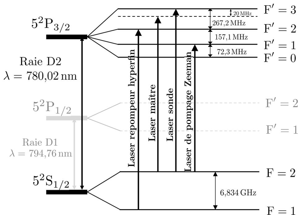
FIGURE II.7 – Structure fine et hyperfine du  $^{87}\text{Rb}$ , avec schéma des transitions optiques adressées lors du piégeage, refroidissement et imagerie des nuages atomiques. Les sous-niveaux Zeeman ne sont pas indiqués.
