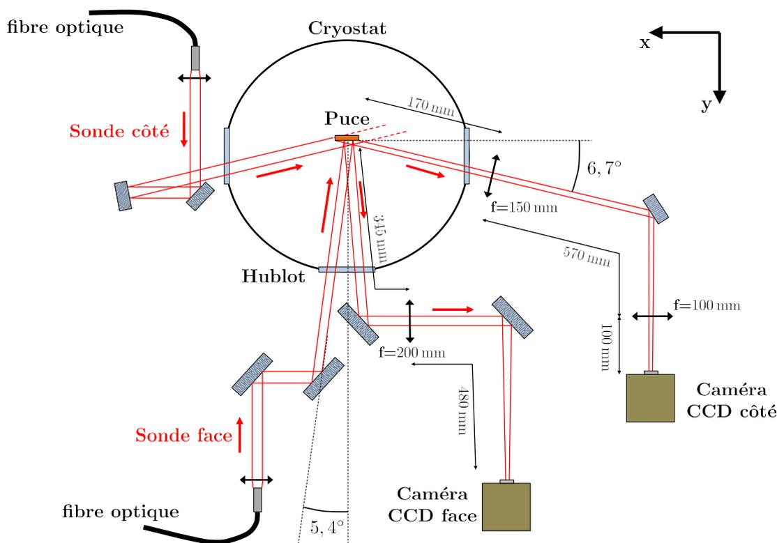
FIGURE II.16 – Système optique de l'imagerie atomique par absorption. Une image de côté ou de face des ensembles atomiques peut être faite en envoyant un des deux faisceaux laser sur les atomes et en détectant leur image par une caméra CCD. Par les faisceaux sondes nous envoyons la lumière en résonance avec la transition  $F = 2 \rightarrow F' = 3$  superposée à la lumière du laser repompeur (*cf.* schéma de fréquences des lasers, fig. II.7).
