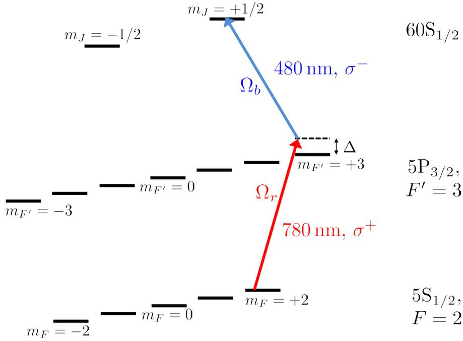
FIGURE III.1 – Schéma de l'excitation laser à deux photons du niveau 60S, à partir d'atomes de  $^{87}\text{Rb}$  dans le niveau fondamental dans le piège magnétique. La polarisation de chaque laser est indiquée.  $\Omega_r$  et  $\Omega_b$  sont les fréquences de Rabi des transitions à 780 et 480 nm, respectivement.  $\Delta = 540 \text{ MHz}$  est le désaccord par rapport au niveau intermédiaire.
