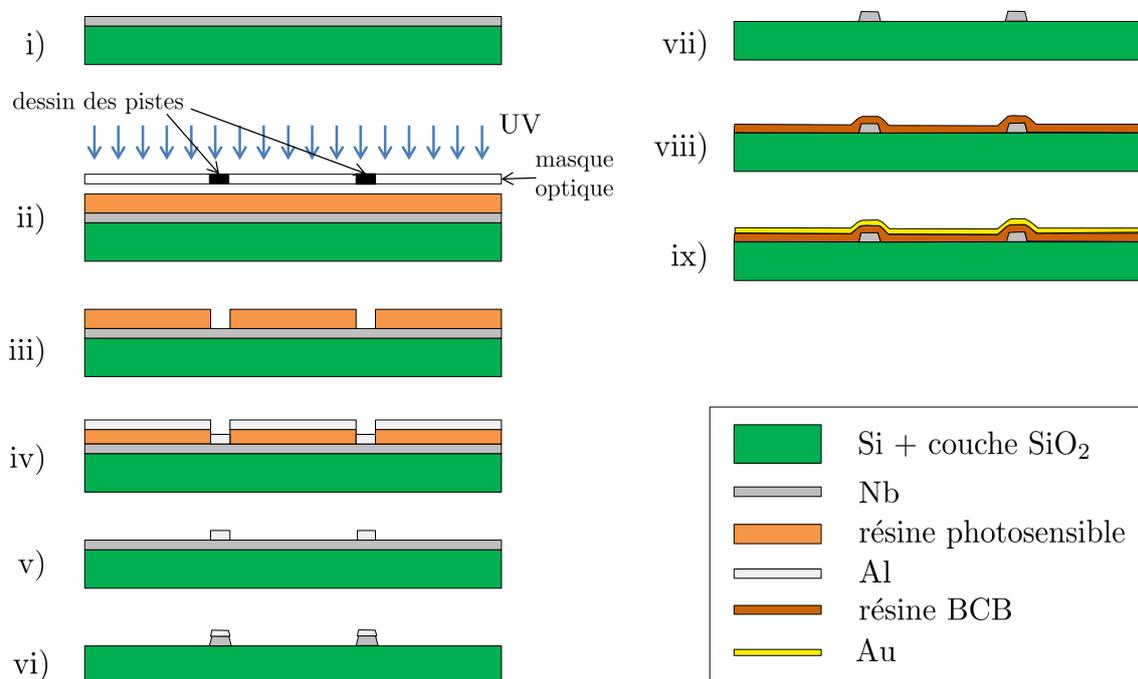
FIGURE A.1 – Différentes étapes de fabrication de la puce à atomes. (i) : dépôt de Nb sur un substrat de Si + SiO<sub>2</sub>. (ii, iii) : lithographie négative du dessin des pistes avec une résine photosensible, AZ5214 A. (iv) : dépôt d'aluminium sur la surface par évaporation. (v) : *lift off* de la résine dans un bain d'acétone. (vi) : gravure ionique réactive du niobium. (vii) : bain dans solution de KOH pour enlever l'aluminium. (viii) : Dépôt de résine polymérique BCB. (ix) : dépôt Ti-Au.
