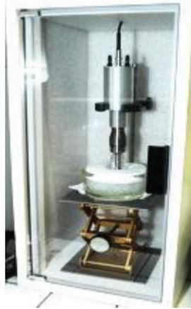
Figure IV 31 : Système de dispersion par sonication (ultrasons)
