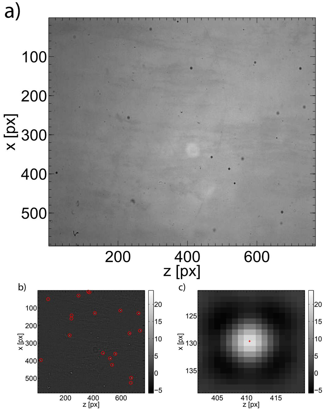
FIGURE VIII.2 – a) Champ de la caméra verticale (environ  $5,7 \times 4,2 \text{ cm}^2$  ici) avec peu de particules de polystyrène de  $250 \mu\text{m}$ . b) Résultat de la soustraction du fond et du filtrage passe-bande sur l'image brute précédente, les cercles sont les particules détectées. c) Zoom sur une particule de l'image précédente où nous marquons le centre détecté d'une croix rouge. La zone négative (noire) correspond à la légère diffraction amplifiée par le filtrage.
