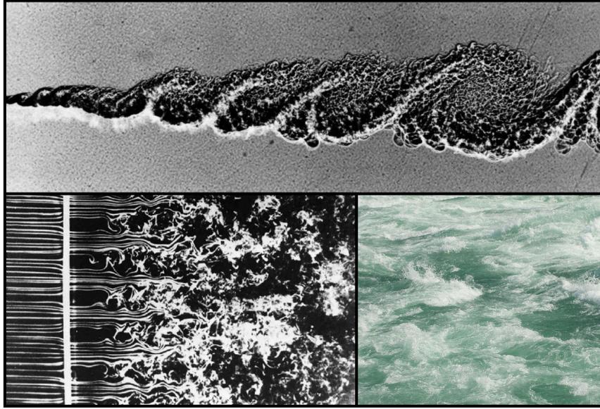
FIGURE I.1 – En haut : Couche de mélange entre deux gaz allant à des vitesses différentes (1 et  $0,4 \text{ m.s}^{-1}$ ). En bas à gauche : écoulement derrière une grille (1 cm de pas de maille) à  $Re = 1500$ . Ces deux premières images sont issues de *An Album of Fluid Motion* [73]. En bas à droite : photographie de la rivière Niagara peu après les chutes.
