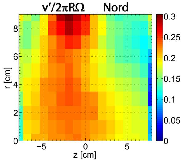
FIGURE V.19 – Magnitude des fluctuations  $v'$  normalisée par la vitesse des disques :  $v'/2\pi R\Omega$  avec  $v' = \sqrt{(2v_\theta^2 + v_z^2)}/3$ . Les données sont issues de mesures LDV effectuées sur une grille de  $11 \times 21$  points, à 4 Hz, lorsque la couche de cisaillement est déplacée vers la gauche, correspondant à un état nord, dans lequel la cellule située en  $z > 0$  domine.
