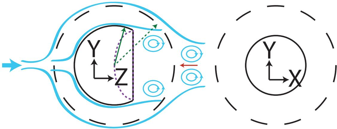
FIGURE C.2 – Schéma de la dynamique de fusion d'une bille de glace dans l'écoulement de von Kármán à un disque. Les pointillés noirs espacés schématisent l'état initial, les traits pleins noirs un état intermédiaire, et les pointillés resserrés violets un état final. Les traits bleus schématisent l'écoulement, et la flèche rouge indique la zone d'effort initiale. Les flèches vertes symbolisent le décollement de la couche limite.
