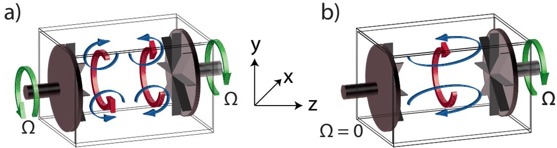
FIGURE II.1 – Schéma de l'écoulement moyen dans un dispositif de von Kármán à section carrée. (a) : deux disques contra-rotatifs produisent deux cellules contra-rotatives azimutales (flèches rouges) et des recirculations méridiennes (flèches bleues). (b) : un disque produit une rotation azimutale forte (flèche rouge) et une recirculation méridienne (flèches bleues).
