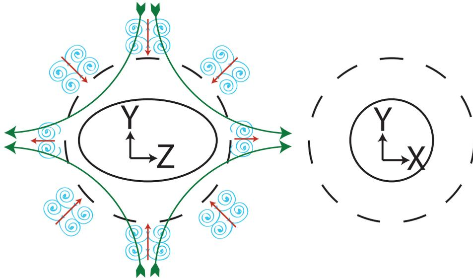
FIGURE C.4 – Schéma de la dynamique de fusion d'une bille de glace dans l'écoulement de von Kármán à deux disques. Le noir correspond à la bille de glace : les pointillés espacés schématisent l'état initial, les traits pleins un état intermédiaire. Les traits bleus schématisent les fluctuations avec la flèche rouge pour la zone d'effort qu'elles entraînent. Les flèches vertes symbolisent l'écoulement moyen local.
