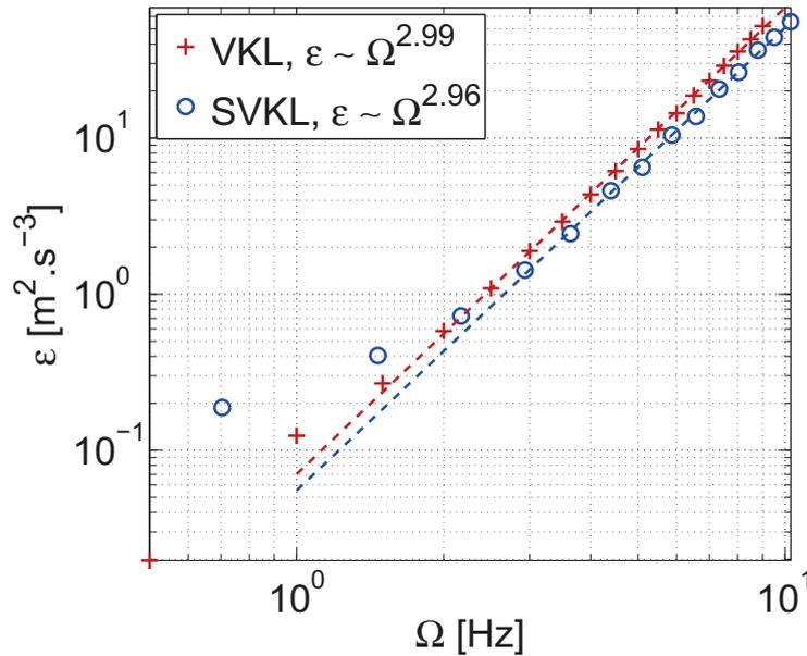
FIGURE II.3 – Taux d'injection d'énergie  $\varepsilon$  estimé à partir de la puissance consommée par les moteurs à différentes fréquences de rotation  $\Omega$ . Les symboles représentent les différents dispositifs, notés VKL et SVKL pour von Kármán Lyon et *small* von Kármán Lyon. Les pointillés sont des ajustements en loi de puissance en ne considérant que les fréquences supérieures à 2 Hz.
