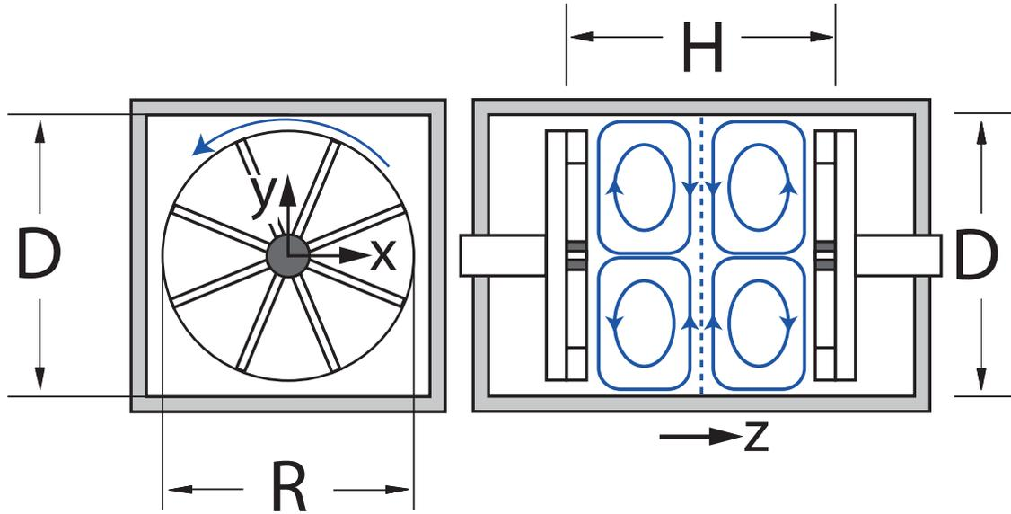
FIGURE II.2 – Schéma du dispositif de von Kármán à section carrée. Les flèches bleues représentent l'écoulement moyen produit par les disques en contra-rotation.
