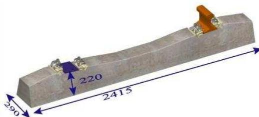
FIGURE 1.4 – Détail d'une traverse monobloc M450.
