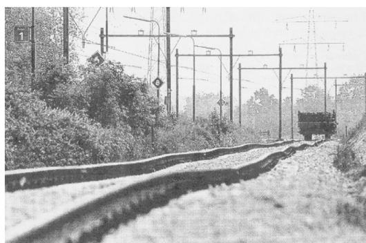
FIGURE 1.7 – *Dégradation géométrique de la voie* [125].
