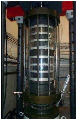
FIGURE 1.9 – *Essai triaxial appliqué sur le ballast*
