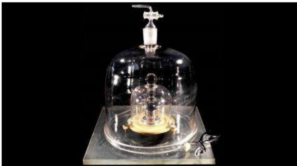
Figure 1-1 : Le kilogramme étalon, conservé au BIPM, composé de 90 % de platine et de 10 % d'iridium
