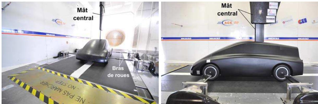
FIGURE 8.1 – Montage expérimental du véhicule à échelle 2/5 (Photos ACE)
