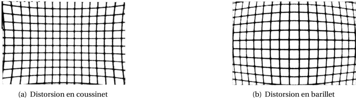
FIGURE 4.1 : Représentation schématique de la distorsion radiale.
