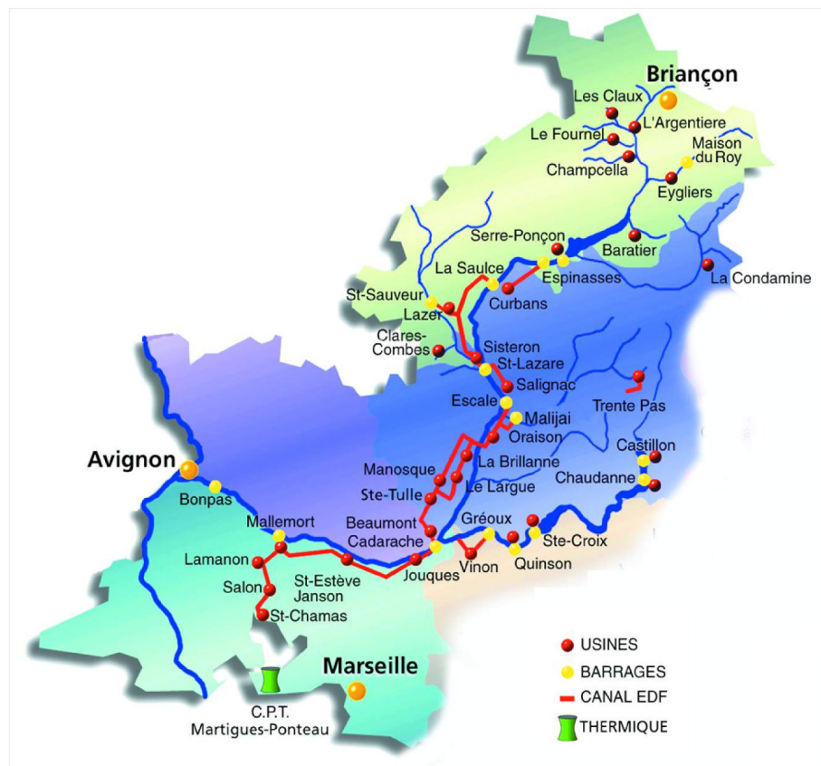
FIGURE 2.8 – Aménagements hydroélectriques de la Durance (source : EDF)
