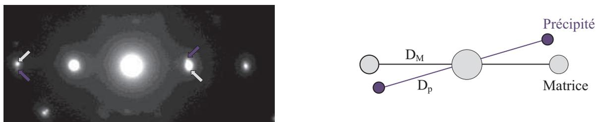
Figure 2 - Cliché de diffraction (a) et représentation schématisée (b) mettant en évidence le précipité considéré et permettant de calculer le taux de désaccord cristallographique.
