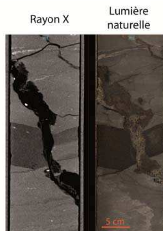
Fig. 6.23 : Image au rayon X (à gauche) de la figure 6.22c (à droite). Le dyke est imprégné d'hydrocarbure alors que le sill ne l'est pas.
