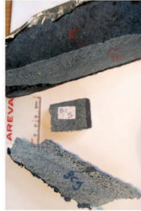
Réseau de SECBs principalement à vergence Sud, très distribué quelques bandes parallèles aux lamines
