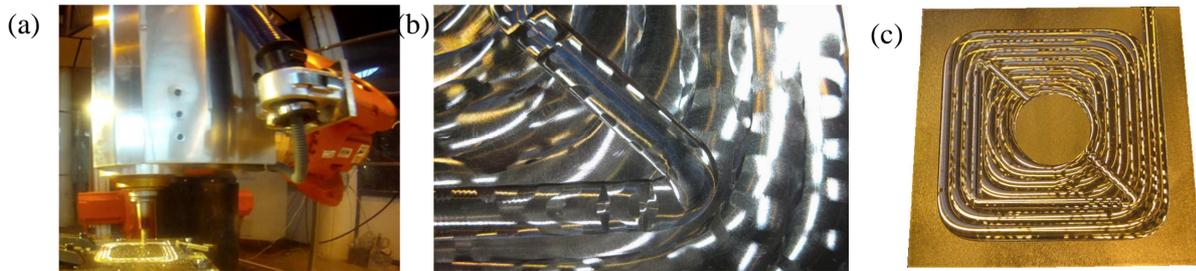
Figure 4-44: Pièce test usinée (a), influence des changements de direction (b), état de surface (c)
