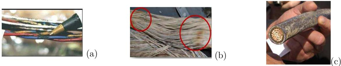
**Figure I.6** – Différents types de vieillissement : a) Contamination chimique. b) Vieillesse thermique. c) Corrosion.
