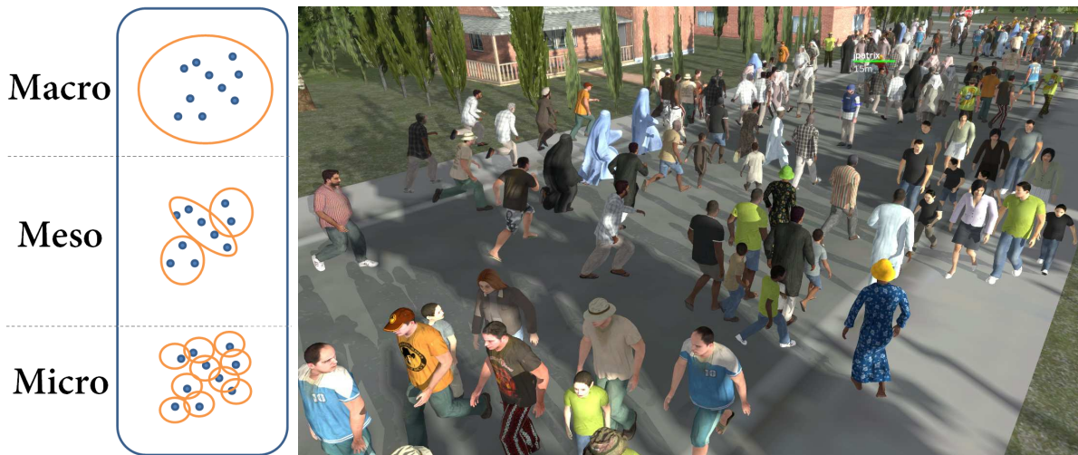
FIGURE 1.3 – Une situation simulée est observable sur trois niveaux de modélisation : macro pour la foule, méso pour les groupes et micro pour les individus.
