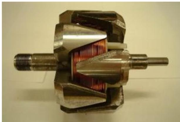
*Figure 2 : Rotor d'un alternateur sans aimant*
