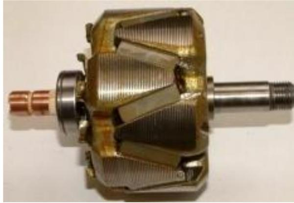
*Figure 3 : Rotor d'un alternateur avec aimants*
