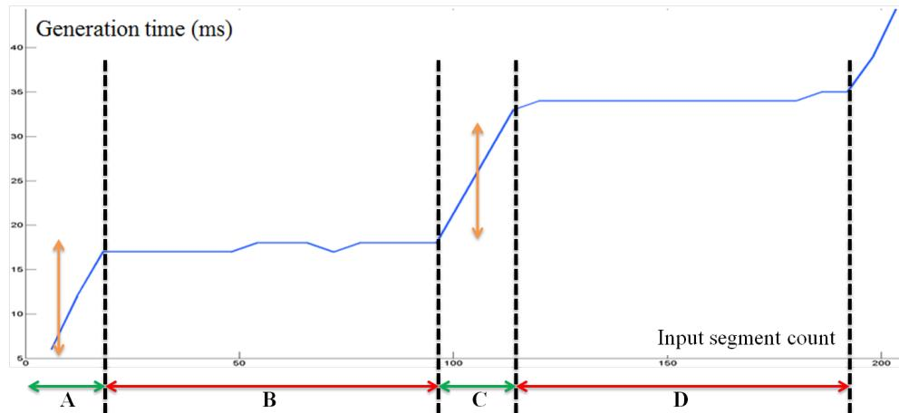
Figure 9.5: Nous observons différents paliers de temps de génération dépendant du nombre d'atomes 1D. Environ 100 atomes sont traités en parallèle à chaque tour de calcul, à un coût moindre. Par exemple, ici 90 segments sont traités au coût de 20, montrant l'efficacité du parallélisme.
