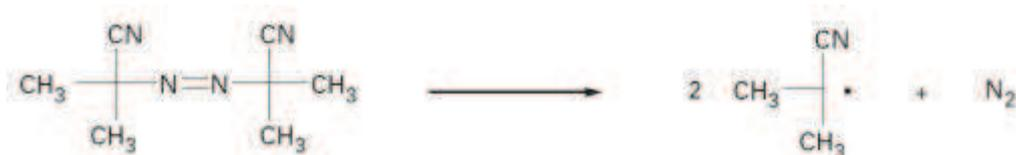
Figure 5-5 : Décomposition thermique par clivage homolytique de l'AIBN.
