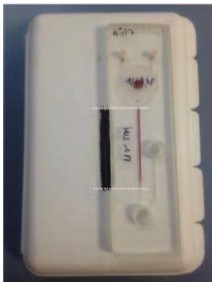
**Figure 6-14 : Masque UV utilisé pour la synthèse localisée des monolithes poly(GMA-co-EDMA) dans les microsyctèmes lab-on-CD : le microsyctème M2 est posé sur le moule et contient le monolithe localisé (coloré en violet).**
