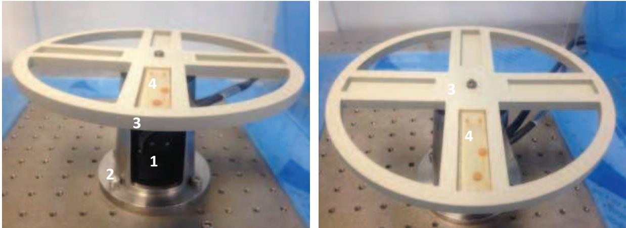
**Figure 6-7 : Plateforme lab-on-CD intégrant : 1. le moteur, 2. le support usiné du moteur, 3. la plateforme lab-on-CD et 4. un microsysteme lab-on-CD de type M2.**
