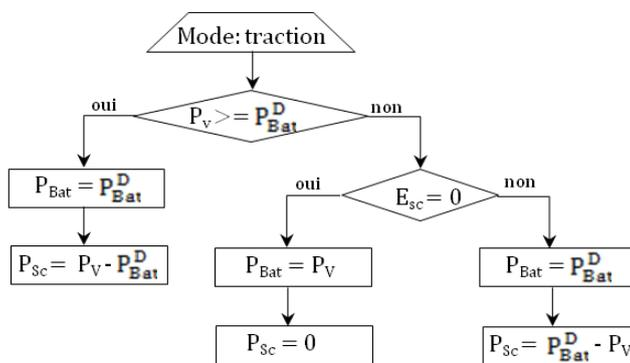
Figure.II. 18 : contrôle de la puissance en mode « traction ».
