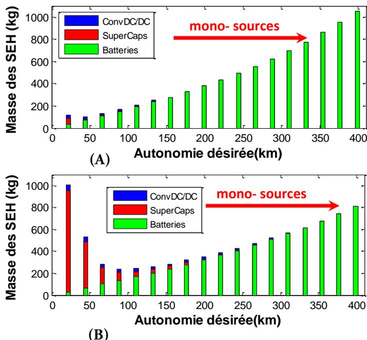
Figure.II. 28: résultats dimensionnement de SEHs en fonction de l'autonomie. Masses des batteries (A) Ko40HP, (B) Ko40HE
