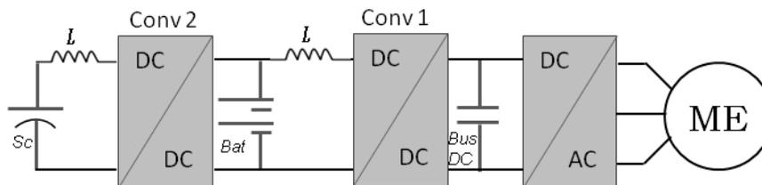
Figure.I. 14 : architecture série avec deux convertisseurs DC/DC
