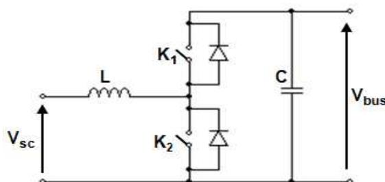
Figure.II. 22: hacheur « Boost ».
