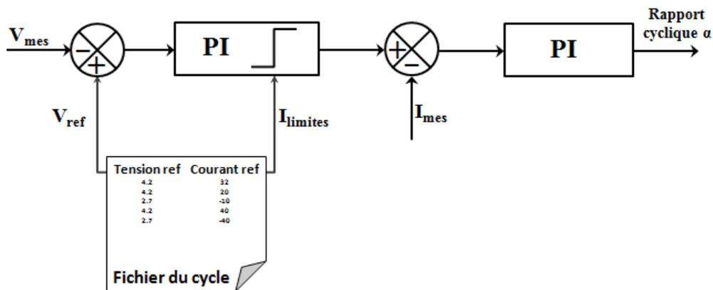
Figure.III. 5 : contrôle de cyclage des cellules de batteries
