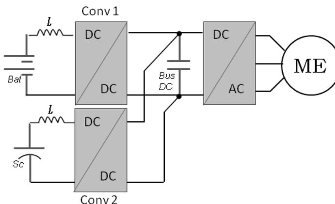
Figure.I. 15 : architecture parallèle avec deux convertisseurs DC/DC
