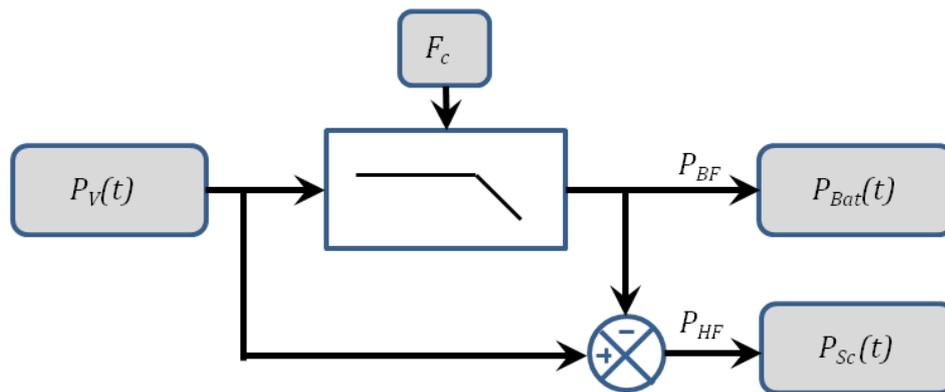
Figure.II. 41 : principe de la stratégie énergétique fréquentielle.
