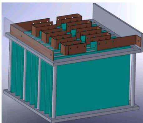
Figure 10 : module tampon (100AH, 34V, 500A/200A)
