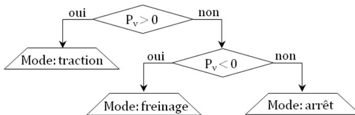
Figure.II. 17 : définition des modes de fonctionnement du VE.
