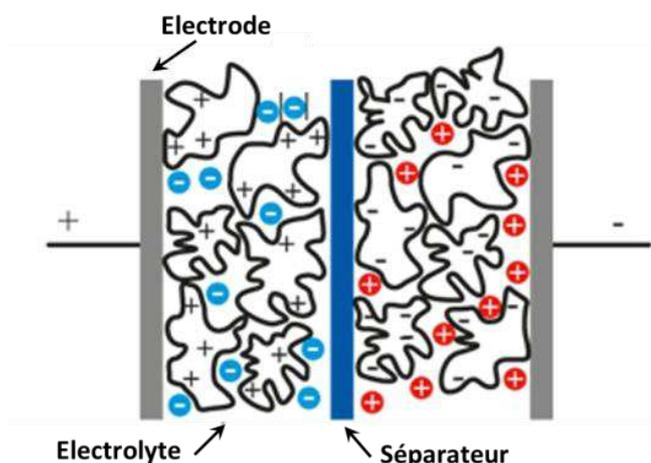
Figure.I. 11 : schéma de principe d'un supercondensateur, [62]
