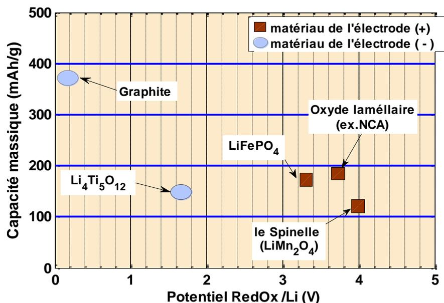
Figure.I. 7:matériaux actuellement utilisés dans les accumulateurs Li-ion, [55], [56]
