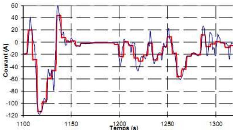
Figure.III. 16 : Exemple de sollicitations d'un VE (Peugeot iOn) en roulage et son découpage en segments de 5 secondes, [109].
