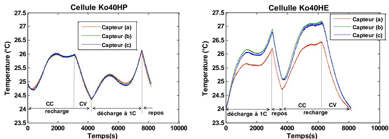
Figure.III. 31 : température des cellules Ko40HP et Ko40HE mesurées par les capteurs a, b et c pendant la caractérisation
