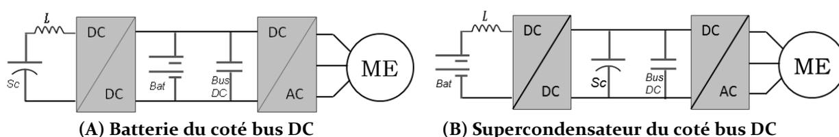
Figure.I. 13 : architectures en cascade avec un convertisseur DC/DC
