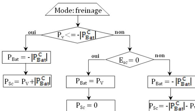
Figure.II. 19 : contrôle de la puissance en mode « freinage ».
