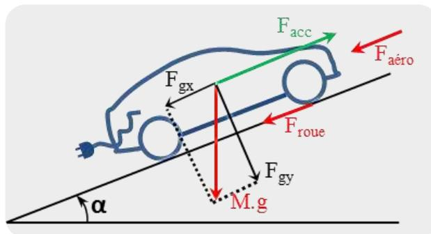
Figure.II. 2 : forces sur un VE en roulement.
