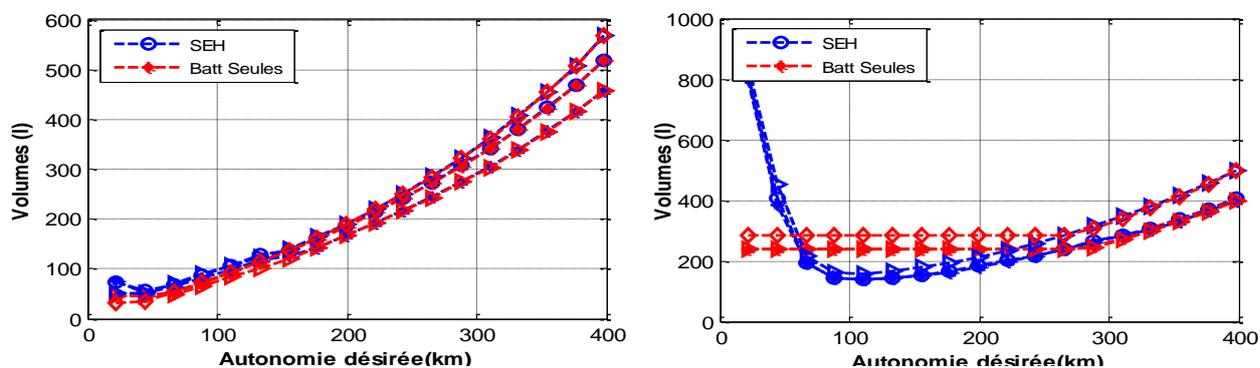
Figure 1 : comparaisons des résultats en volumes des dimensionnements batteries « seules » et SEHs. (A) batteries HP. (B) batteries HE
