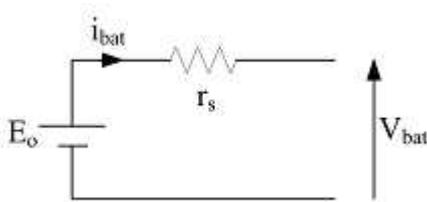
Figure.III. 7 : modèle de résistance interne
