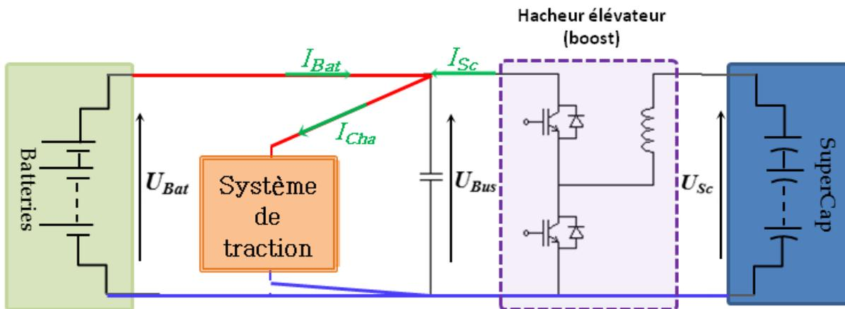
Figure.II. 5 : structure d'hybridation batteries Li-ion/supercondensateurs étudiée
