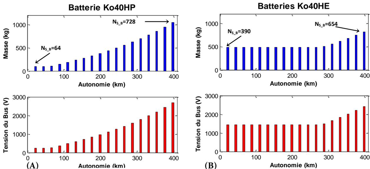
Figure.II. 11: dimensionnement batteries "seules" en fonction de l'autonomie. Masses des batteries (A) Ko40HP, (B) Ko40HE
