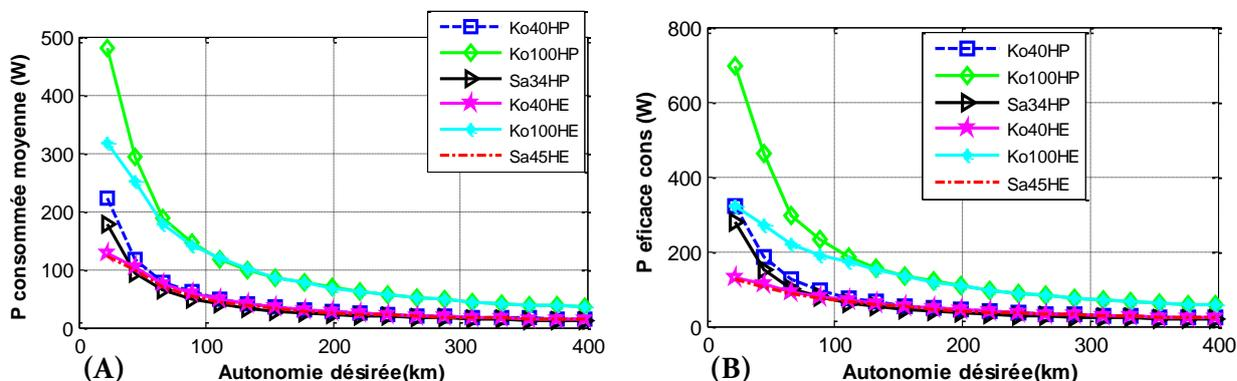
Figure.II. 30 : puissances moyenne (A) et efficace (B) consommées, assurées par une cellule de batteries.
