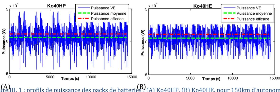
Figure.III. 1 : profils de puissance des packs de batteries : (A) Ko40HP, (B) Ko40HE, pour 150km d'autonomie
