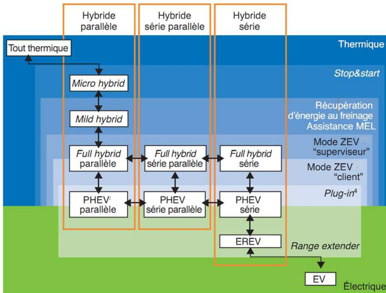
Figure.I. 4: les familles de véhicules hybrides et électriques, [38].
