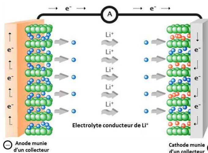
Figure.I. 6:principe de fonctionnement d'une batterie Li-ion, [53].
