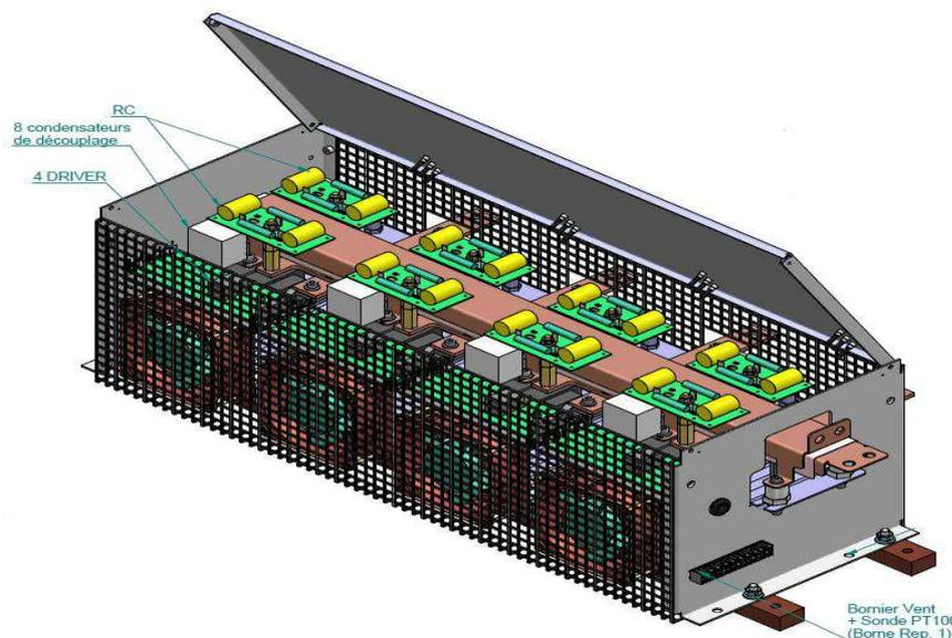
Figure 6: convertisseur 4 bras (600A, 60V, 40kHz),
