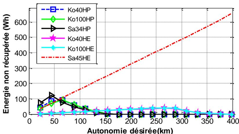
Figure.II. 12 : quantité d'énergie non récupérée par les packs de batteries.
