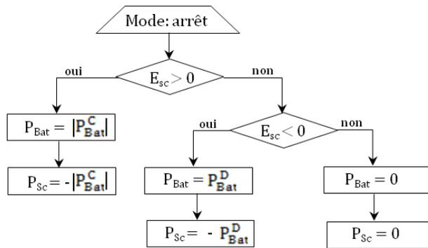
Figure.II. 20 : contrôle de la puissance en mode « arrêt».
