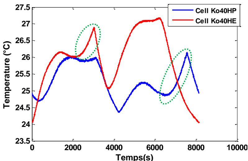
Figure.III. 32 : comparaison de l'évolution de la température des cellules Ko40HP et Ko40HE pendant la caractérisation.
