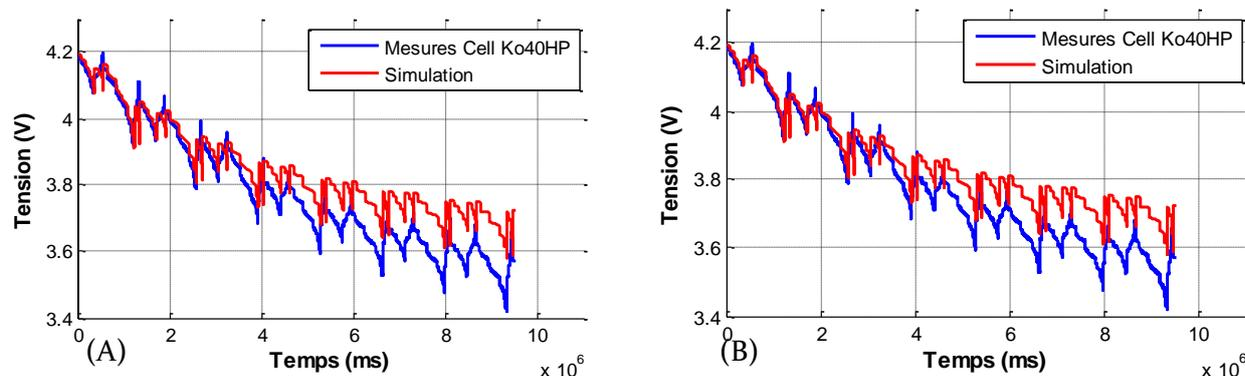
Figure.III. 20 : variation de la tension pendant le cyclage des cellules de batteries HP (A) et HE (B).
