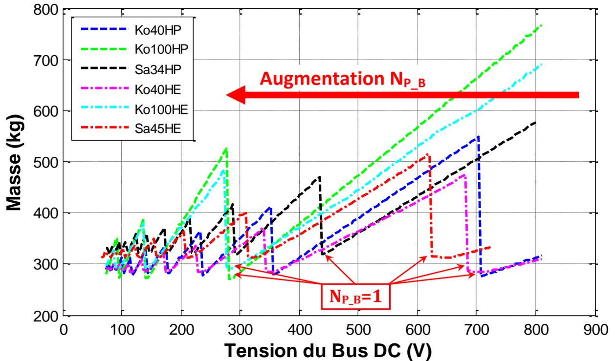
Figure.II. 39 : masses des SEHs en fonction la tension du bus continu
