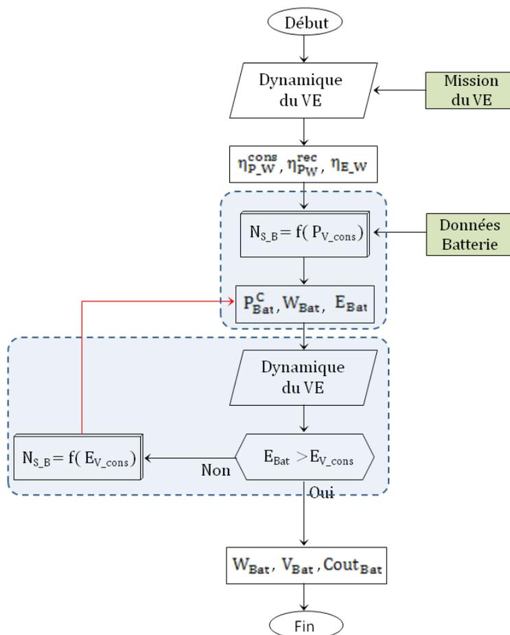
Figure.II. 8: algorithme de dimensionnement-cas d'alimentation du VE par des batteries « seules ».
