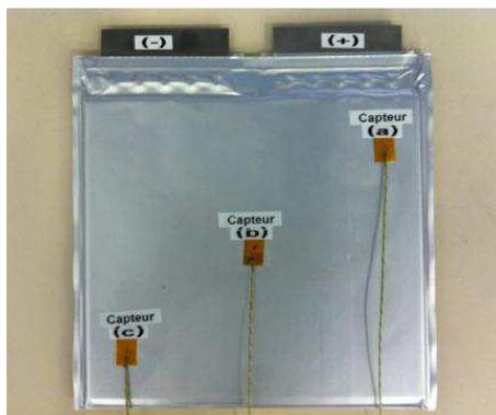
Figure.III. 2: exemple de cellule de batterie testée, positionnement des capteurs de températures
