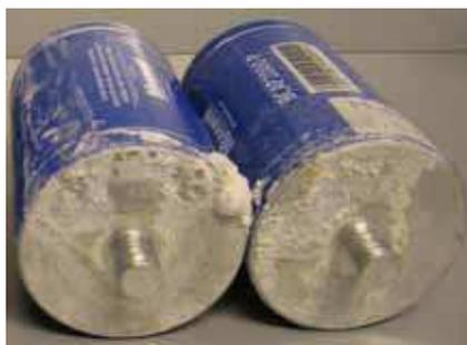
Figure 3.11 Défaillance liée aux essais de vieillissement calendaire
