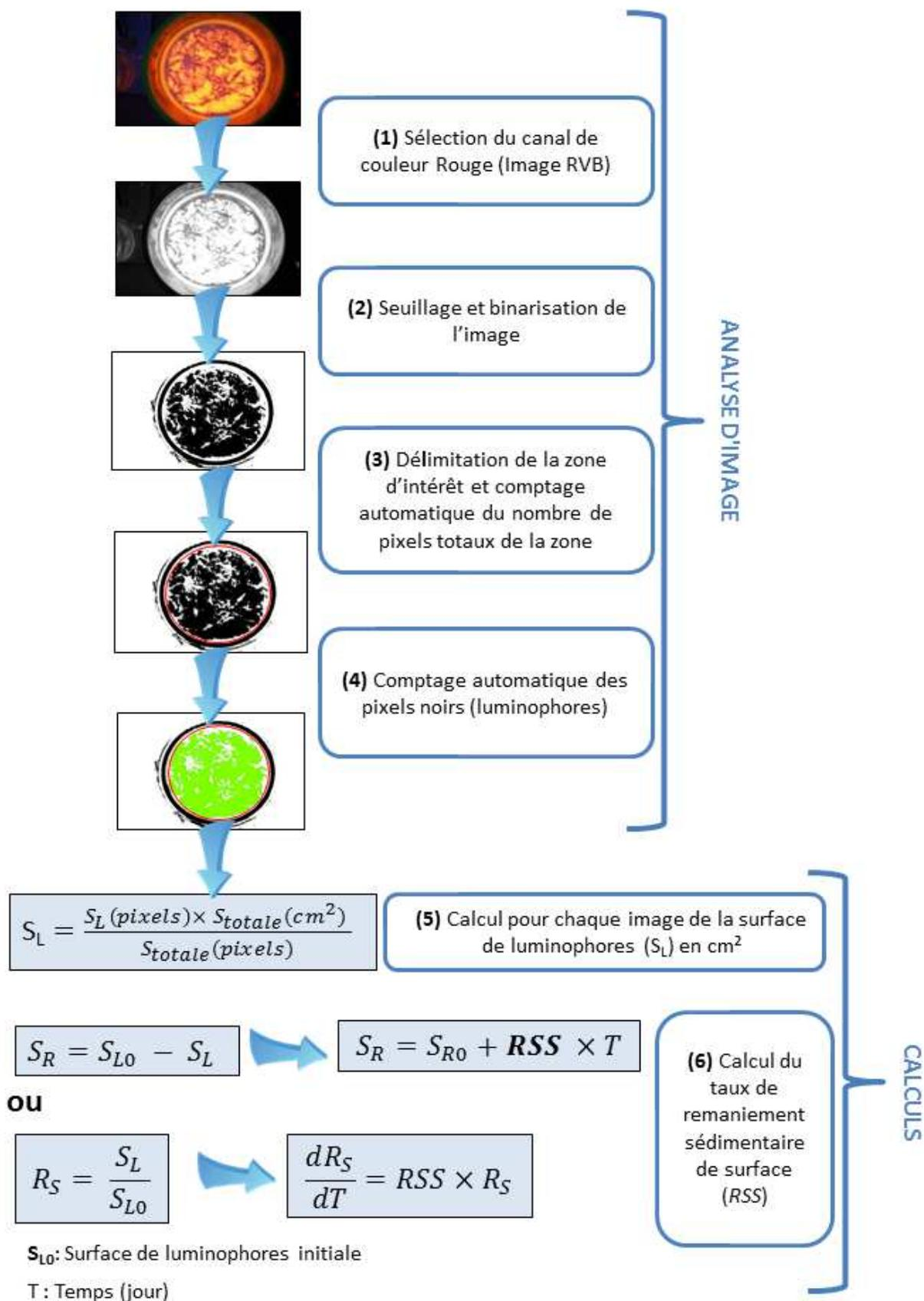
**Figure IV.2** Déroulement du traitement d'image pour obtenir le taux de remaniement sédimentaire de surface par la méthode de disparition des traceurs. Les différentes étapes sont numérotées de 1 à 6.
