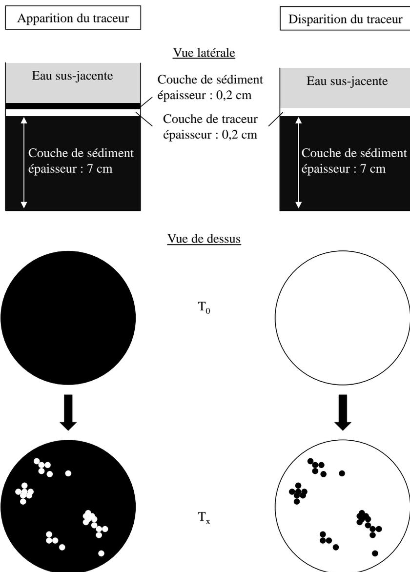
**Figure IV.1** Représentation schématique du principe des deux méthodes de quantification du traceur : apparition (gauche) et disparition (droite) du traceur. Les vues latérales montrant l'agencement des couches des différents matériaux et les vues de dessus au commencement ( $T_0$ ) et au cours de l'expérience ( $T_x$ ).
