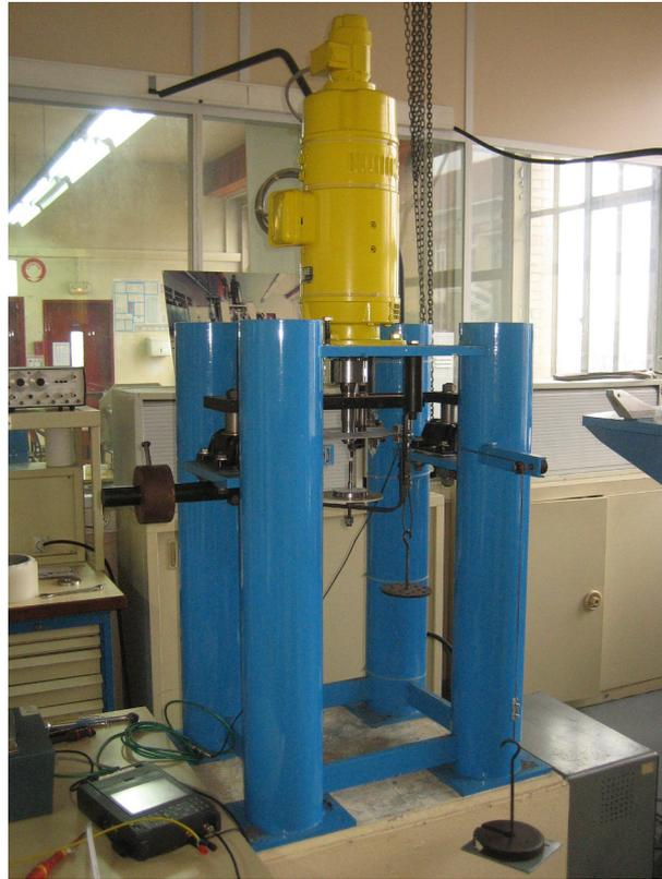
Figure II.31 - Tribomètre bi-pion du LISMA
