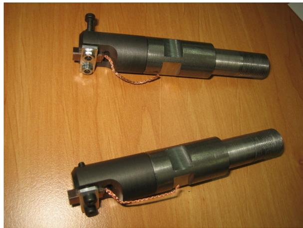
Figure II.35 - Porte-balais spécifiques isolés électriquement pour le Tribomètre bi-pion du LISMA
