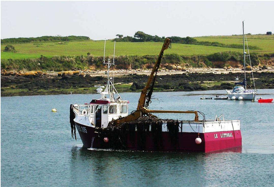
Figure 7: Bateau d'un goémonier équipé d'un scoubidou. Image Marine Robuchon
