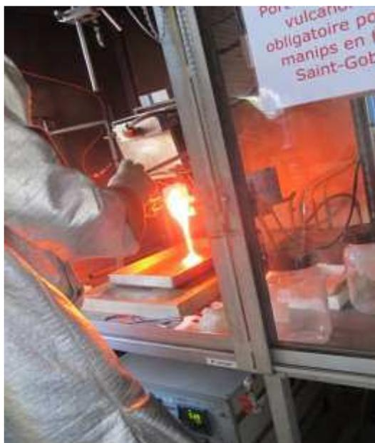
Figure 141. Photo d'une coulée sur plaque à 1300°C après élaboration en four Saint Gobain par basculement du creuset.
