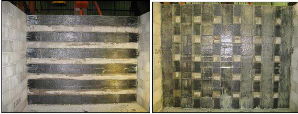
Fig. 2.18. Renforcement horizontal et vertical du mur n°3
