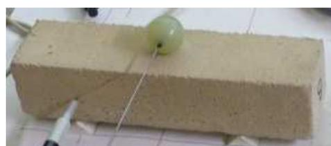
Fig. 2.36. Test Grindosonic : Flèche = capteurs piézo-électrique, croix = lieu d'impact
