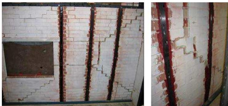
Fig. 2.17. Polymères renforcés des fibres de carbone [WIL 2009]
