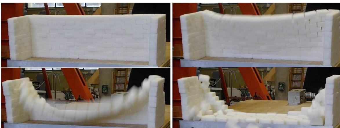
Fig. 4.72. Processus de rupture de l'essai  $L_1$  avec un rapport  $L/h=3.2$ .
