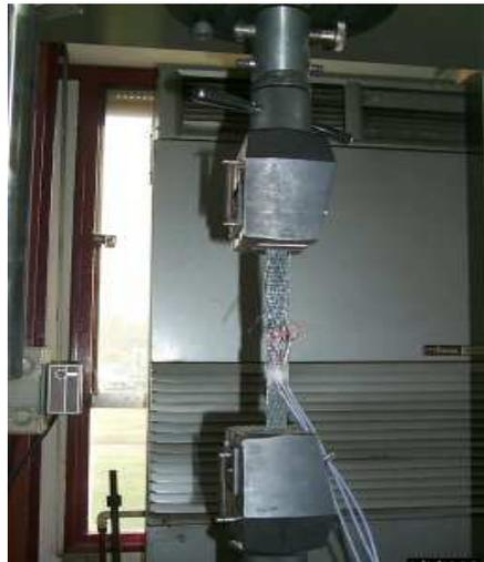
Fig. 2.66. Banc d'essai pour TFC
