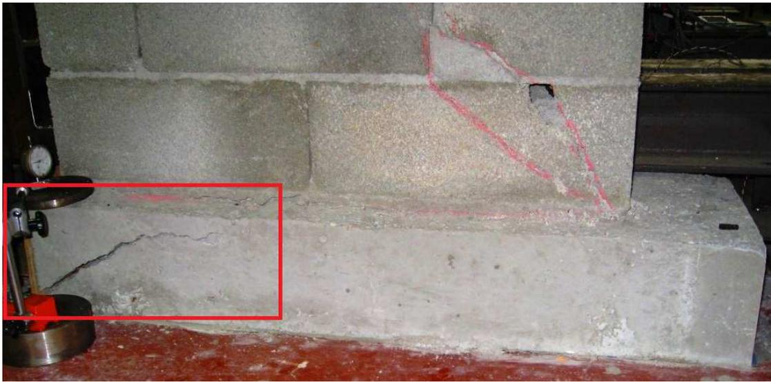
Fig. 2.71. Grande fissure au niveau de la semelle
