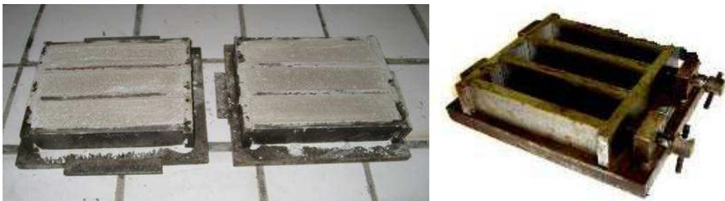
Fig. 2.35. Moules et éprouvettes de mortier
