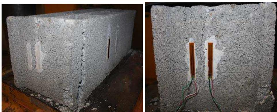
Fig. 2.45. Modes de rupture du bloc
