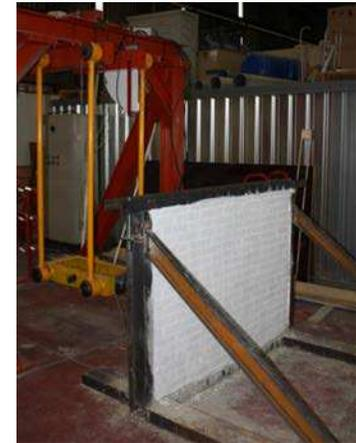
Fig. 4.110. Banc d'essai: pendule de Mouton-Charpy et support du mur (unité en mm).
