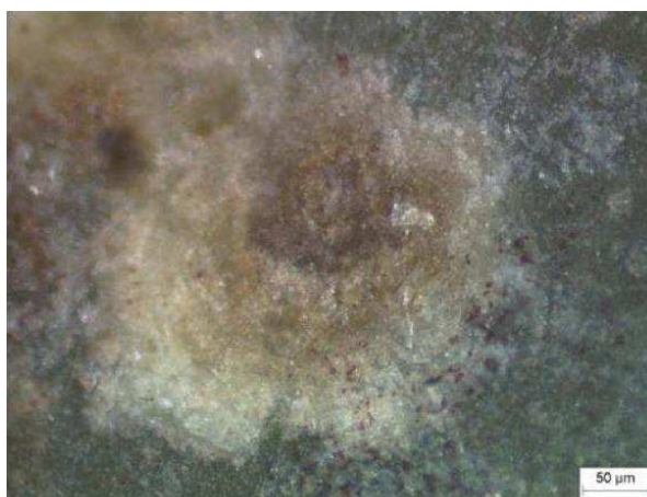
Figure 4-32 : Observation au microscope optique d'une tache se trouvant sous la surface du verre. Elle a un aspect légèrement voilé. Echantillon GUEND : Face interne.
