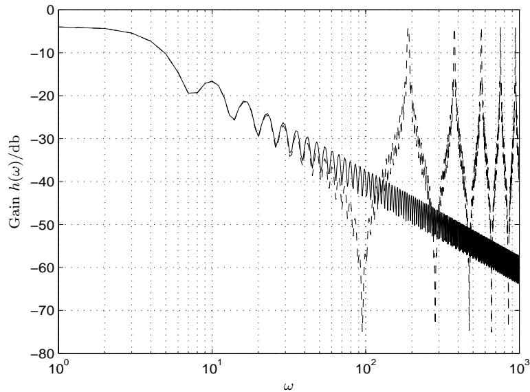
FIGURE 2: Diagramme de Bode en gain de  $\hat{\theta}_1(s)$  et de son approximation obtenue par la un schéma d'intégration numérique trapézoïdal à 30 noeuds.
