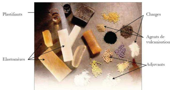
Figure 1-12 : Composition d'un mélange de caoutchouc [Koscher, 2003]
