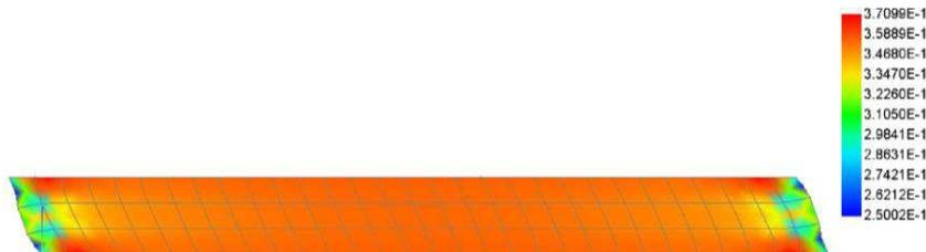
Figure 4-9 : Distribution du degré de réticulation  $\gamma = 50\%$
