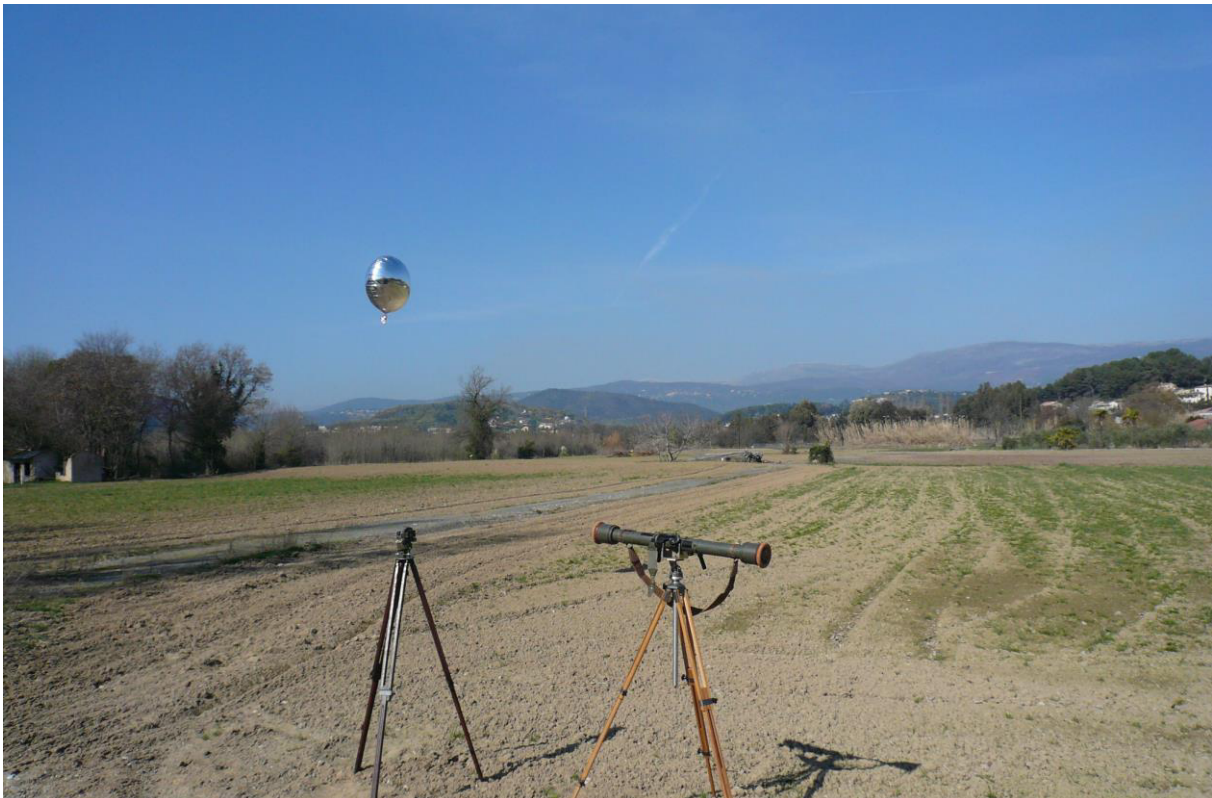
Figure 156. CLB lâché dans la brise d'aval (vallée-mer), à partir du lieu-dit des Prés Neufs à la Roquette-sur-Siagne, le 28/02/2012 vers 12h. Vue vers le nord-ouest. A gauche : le théodolite ; à droite : le télémètre. (© Michelot).
