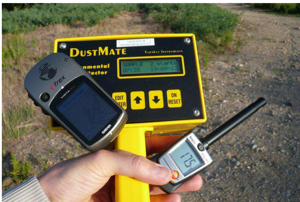
Figure 94. Matériels emportés manuellement lors des mesures itinérantes. De gauche à droite : le GPS Garmin, l'analyseur de particules DustMate, et la sonde Testo. (© Michelot).
