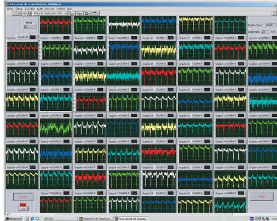
FIGURE 2.27. – Interface du programme d’acquisition montrant les 60 voies. Les signaux ont été acquis avec une fréquence d’échantillonnage de 1 kHz.
