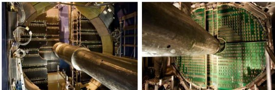
FIGURE 2.27 – Photographies montrant la géométrie en quadrants des stations 1 et 2 (gauche) et la géométrie en lattes des stations 3, 4 et 5 (droite).
