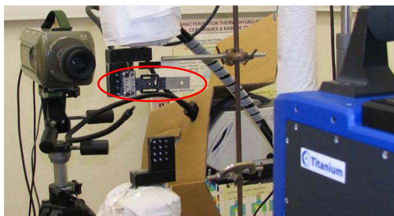
Figure 6.16. Mire de recalage en position des images issues des deux caméras.
