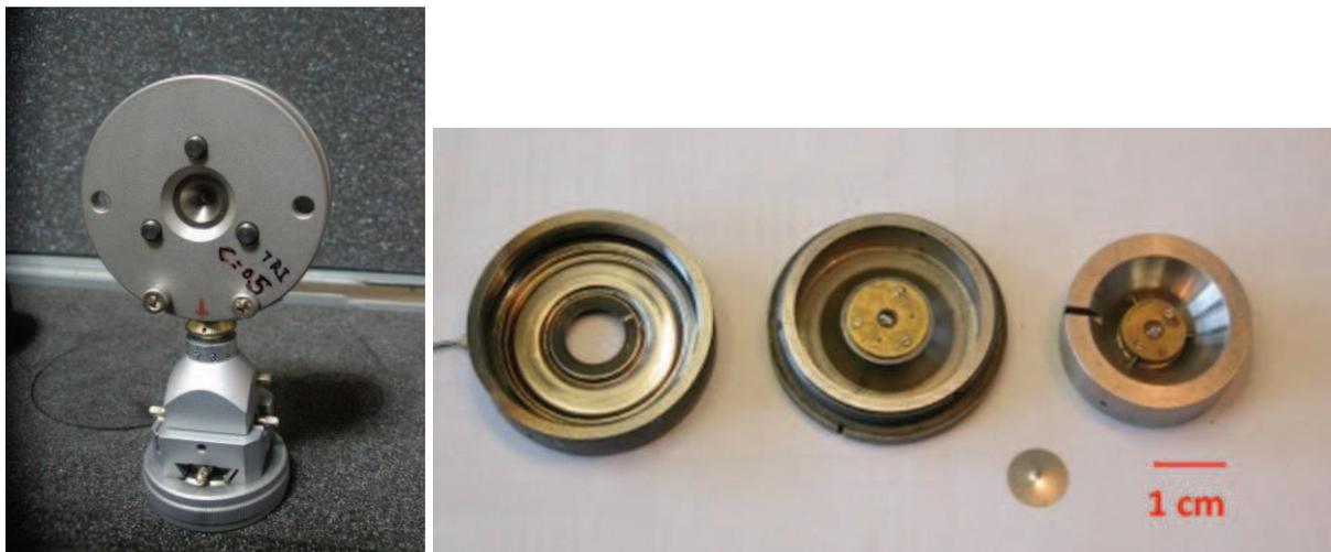
Fig. 2.7: Cellule à enclume de diamant à vis de type Almax (à gauche) et CED à membrane de type Chervin (à droite) utilisées dans les expériences sous pression de diffraction de rayons X et de spectroscopie Raman respectivement.
