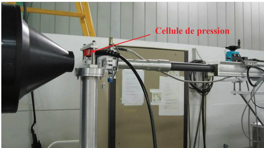
Fig. 2.28: Photo de la cellule de pression installée sur PAXE pendant une expérience.
