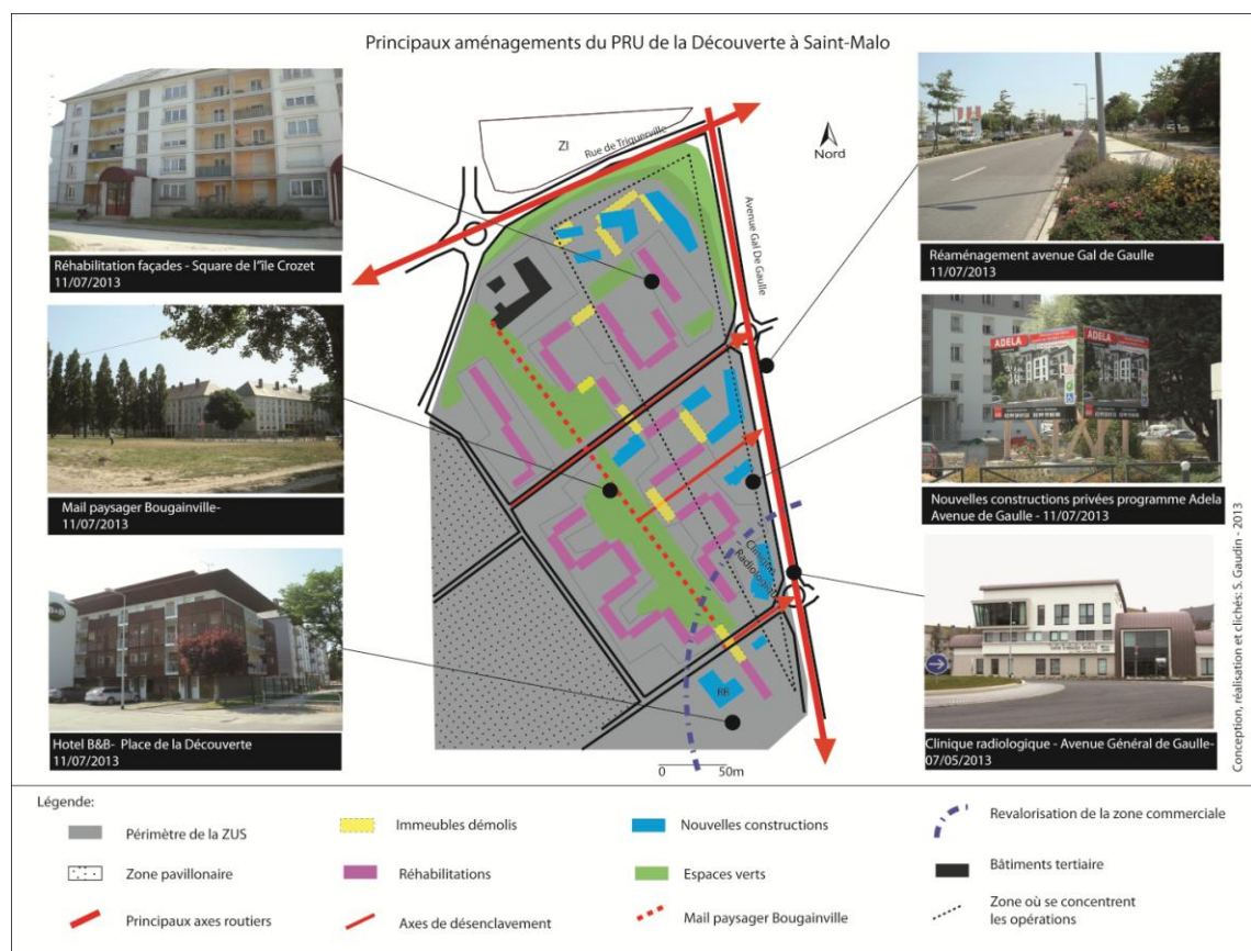
Figure 7.21 – Les principaux aménagements du PRU de la Découverte à Saint-Malo – Réalisation personnelle
